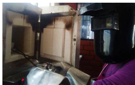
Tratamiento térmico en atmósfera inerte a 600 °C
