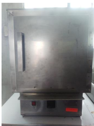
Horno fijo de activación de °T máxima de 1200 °C trifásico, de 220v
