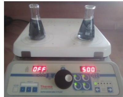
Agitación del carbón activado y la solución de plomo en fase acuosa
