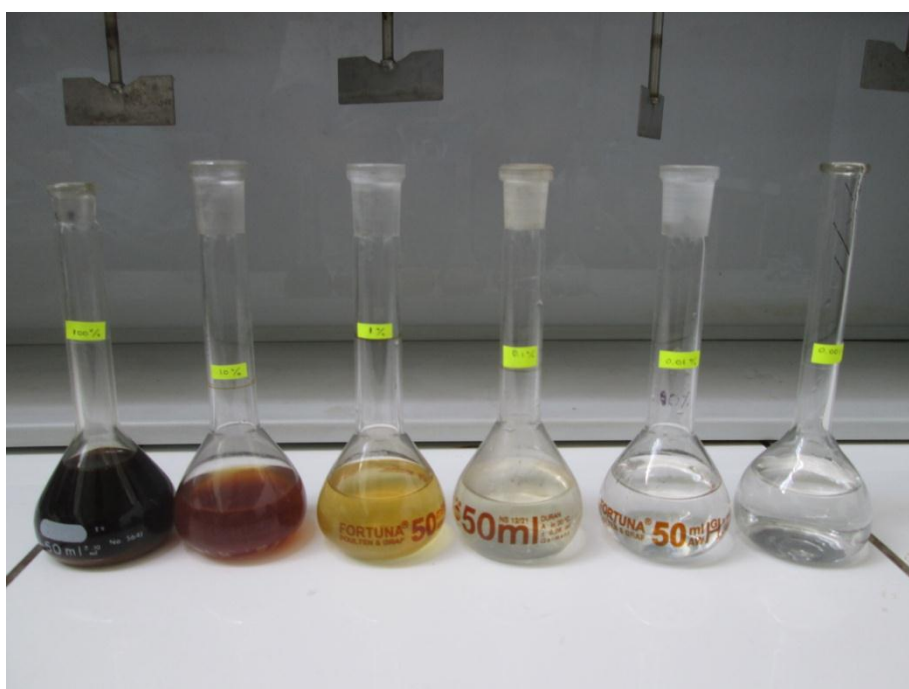
Fotografía 14: Diluciones del Biol III-G para el ensayo de fitotoxicidad
