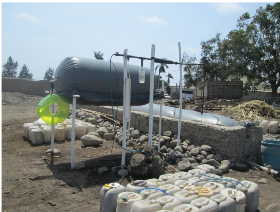
Fotografía 9: Toma de muestra de biogás
