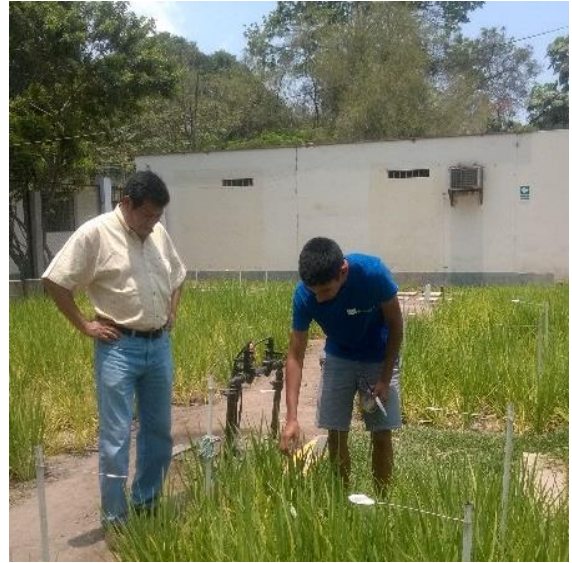
Continua verificación y renovación de cinta en la unión entre los sensores térmicos de termocuplas y las hojas.
