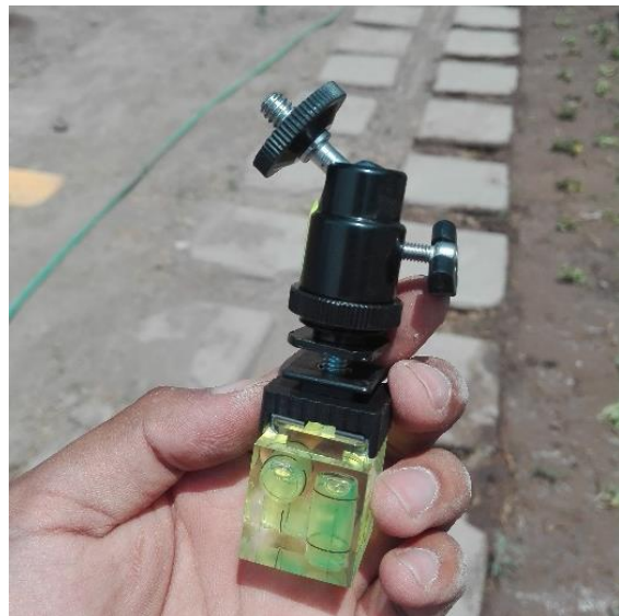
Acondicionamiento de rótula y nivel de tres burbujas para la cámara termográfica.
