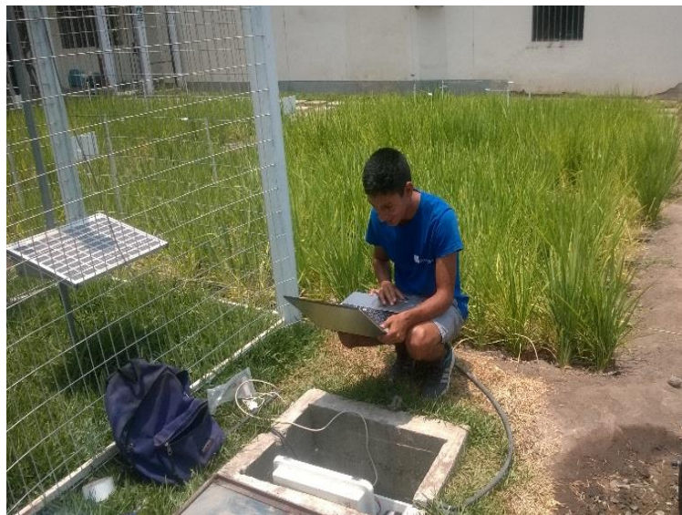
Recolección de información almacenada en el data logger mediante el uso de una laptop y cable HDMI.
