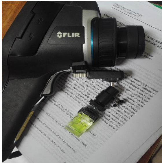
Preparación en gabinete de la cámara termográfica (colocación de batería, lente, rótula y nivel de tres burbujas).
