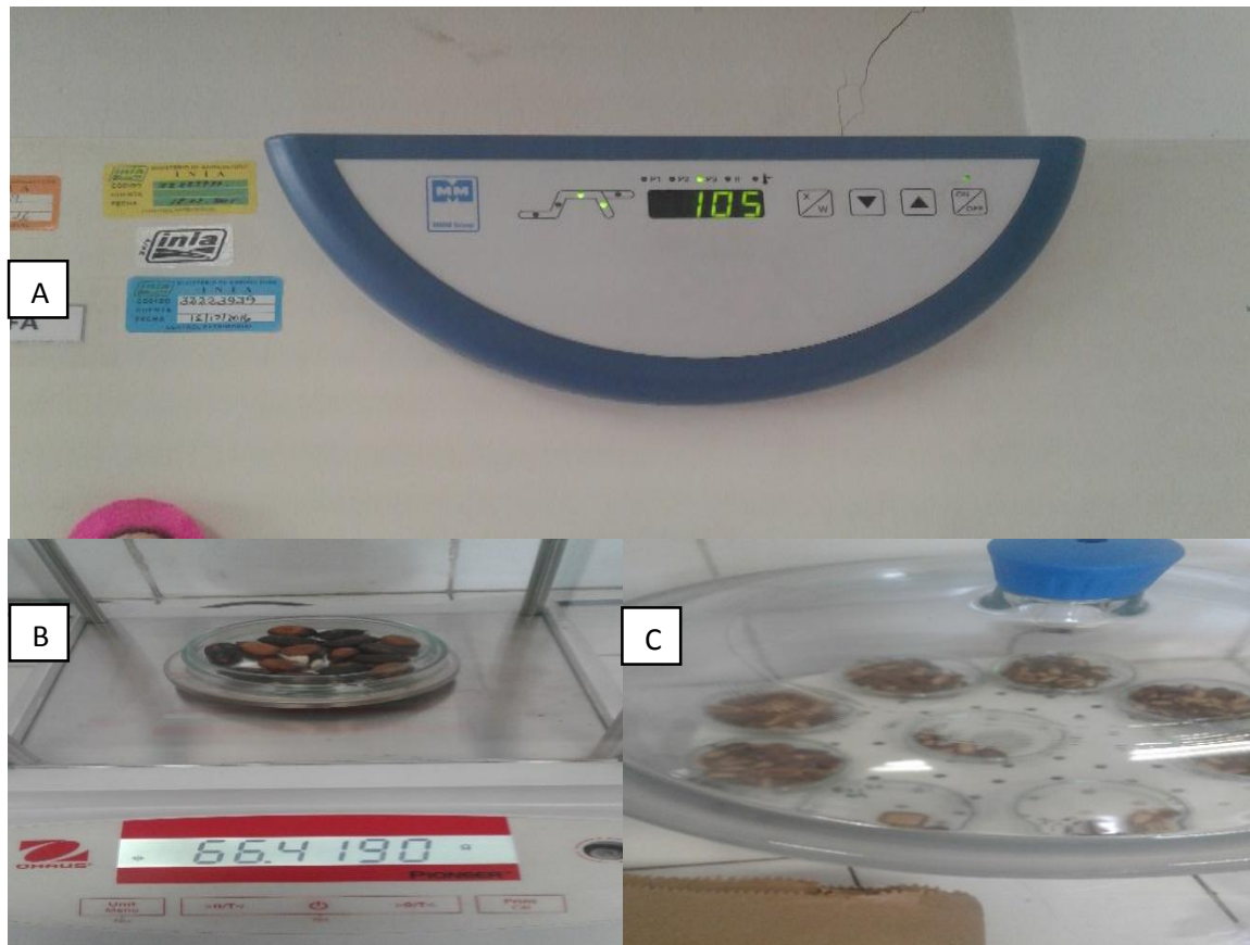
Figura 5. Proceso de secado de la semilla: A: temperatura usada en la estufa, B: pesado de 10 gramos de semilla antes de entrar a la estufa, C: Temperado de la semilla en un desecador de vidrio.
