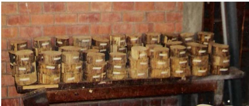
**Figura 12** Rodajas de madera preservada de la especie Palo Gusano para los análisis de Penetración y Retención.
