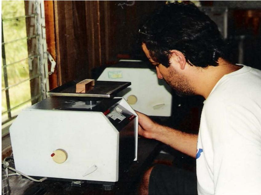
**Figura 3** Pesado de probetas para la determinación de la densidad básica de las maderas estudiadas
