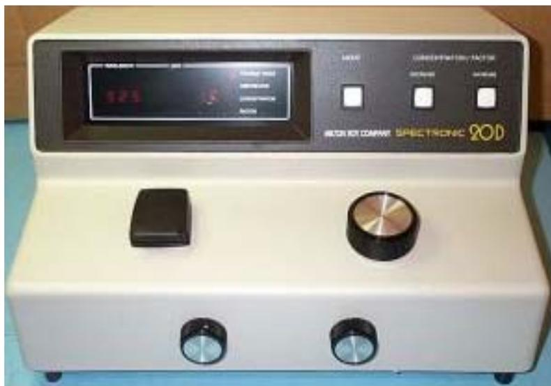
**Figura 14** Espectrofotómetro Spectronic 20D
