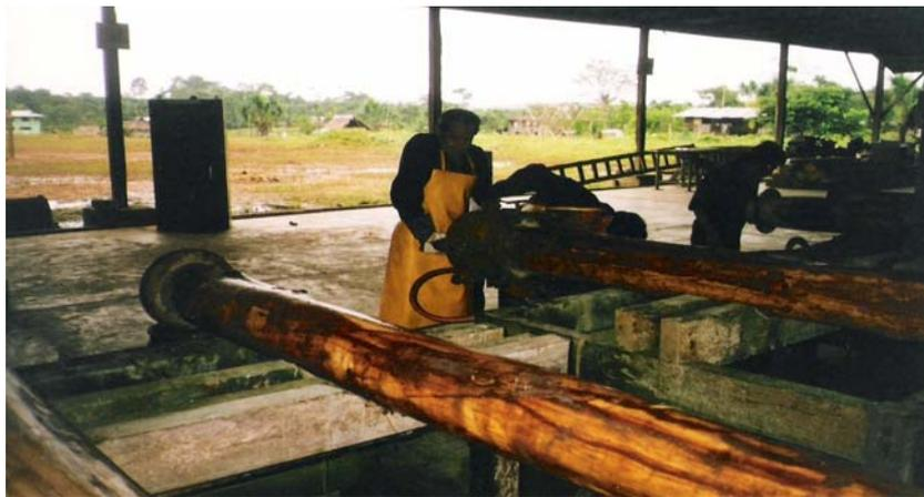
**Figura 9** Postes en proceso de preservado por el método Prescap
