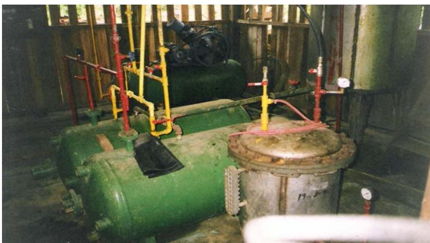
**Figura 8** Tanques de inyección del equipo de preservación Prescap
