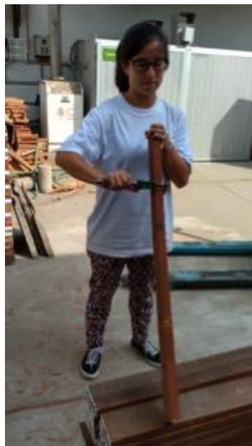
Figura 16: Medición de espesores iniciales de tablas del ensayo de cepillado.
