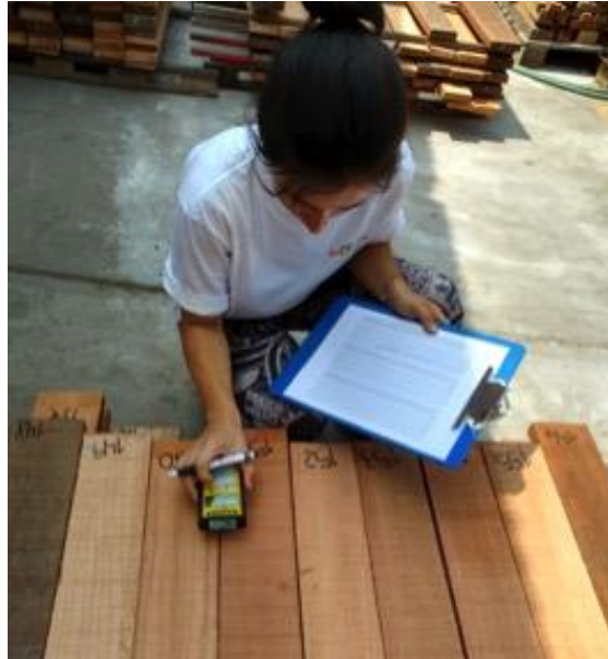
Figura 15: Medición de contenido de humedad con higrómetro de contacto.
