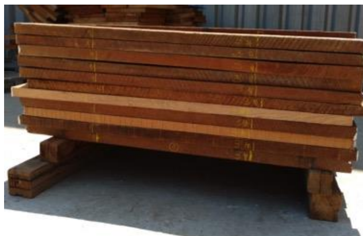
Figura 14: Marcación de puntos de medición de espesor en tablas para el ensayo de cepillado.
