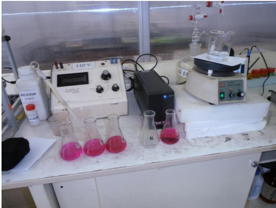
Fotografía N° 12: Pruebas preliminares para adiestrar el ojo humano al color del punto final de viraje (el primer matraz válido empezando desde la izquierda).
