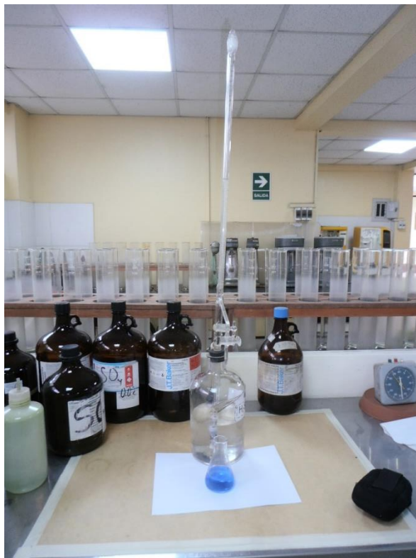
Fotografía N° 6: Bureta empleada para la titulación del destilado obtenido con el equipo micro-Kjeldahl.
