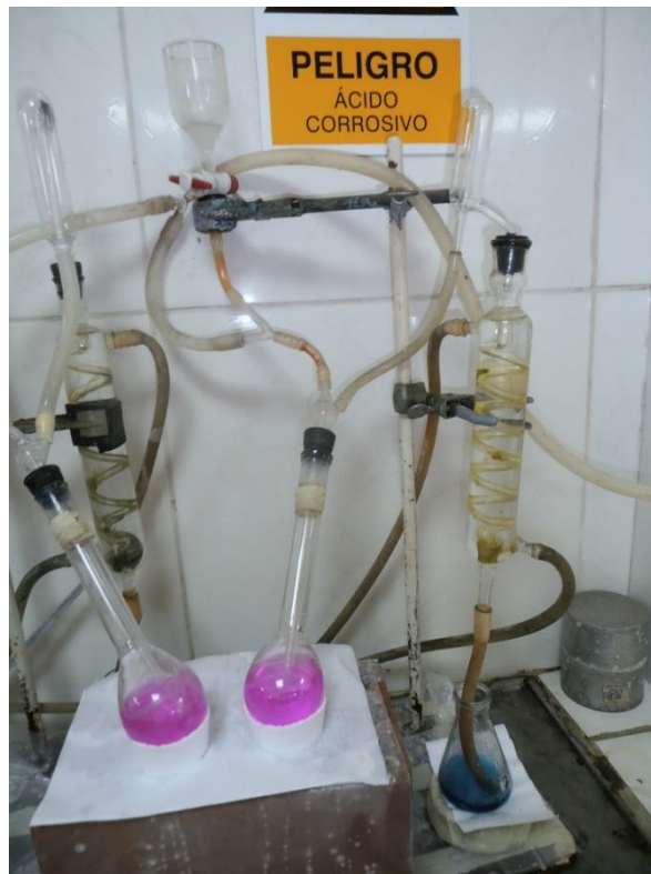
Fotografía N° 4: Detalle donde se observa la obtención del destilado del amonio en el matraz del lado inferior derecho.
