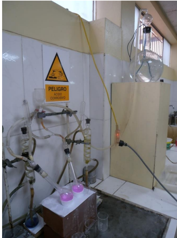
Fotografía N° 3: Equipo de destilación micro-Kjeldahl utilizado en el presente estudio con dos muestras en destilación.
