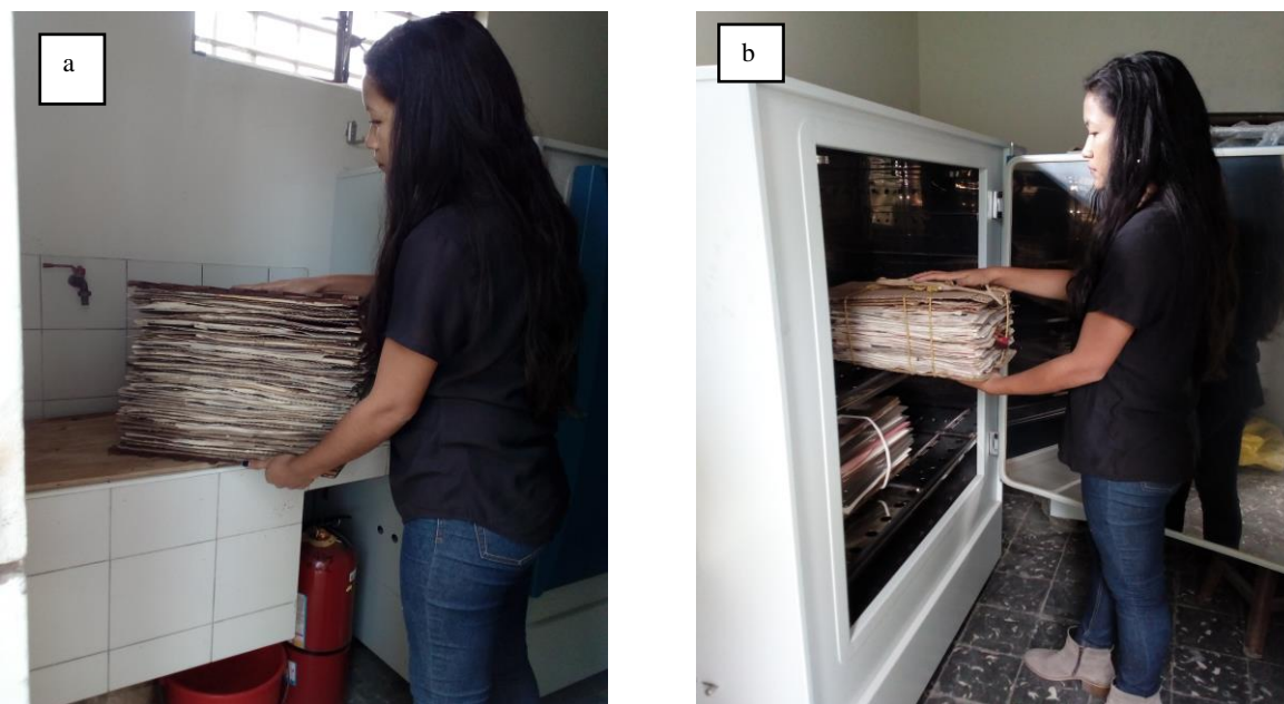
a) Prensa de muestras con el metal corrugado b) Secado del paquete de muestras, en el horno Figura 10: Acondicionamiento de las muestras para el proceso de secado
