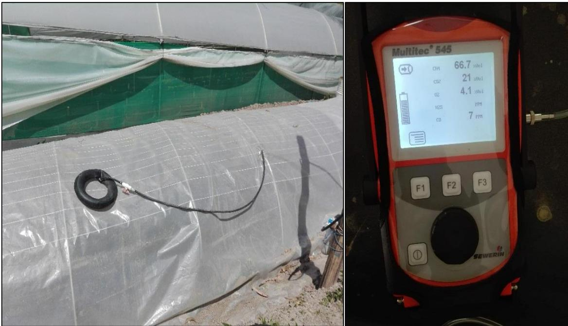
**Figura 23: Medición de biogás en campo.**
