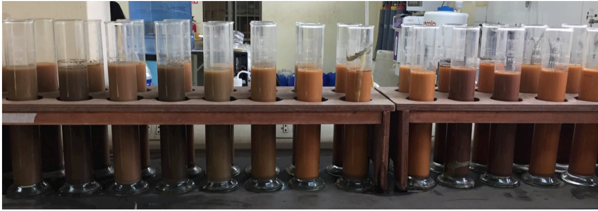
Figura 34: Probetas para determinar textura de suelo.
