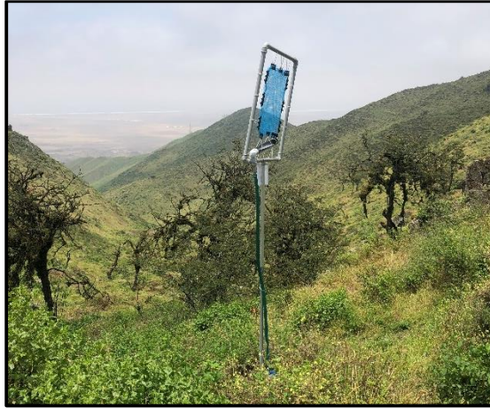
Figura 12: Neblinómetro ASI-03 instalado por SUMP
