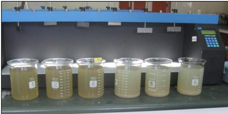
**Determinación de la dosis óptima de sulf. Al.**
