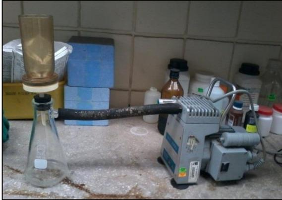
**Equipo de filtración con bomba de vacío**
