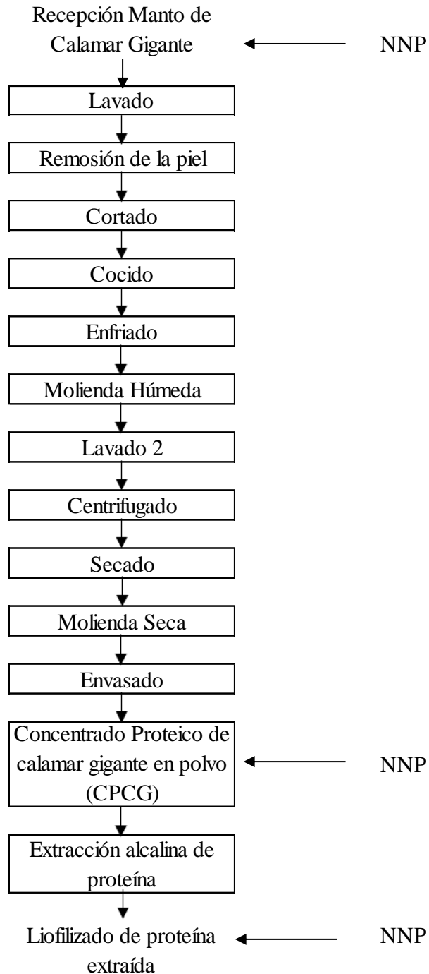
FIGURA 6. Flujograma para elaborar concentrado proteico en polvo de calamar gigante ( Dosidicus gigas )
