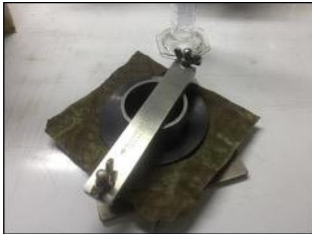
**Figura 12: Equipo de control de absorción de agua COBB**
