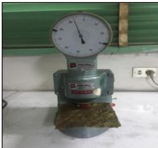
**Figura 11: Micrómetro (instrumento para medir espesor de láminas)**
