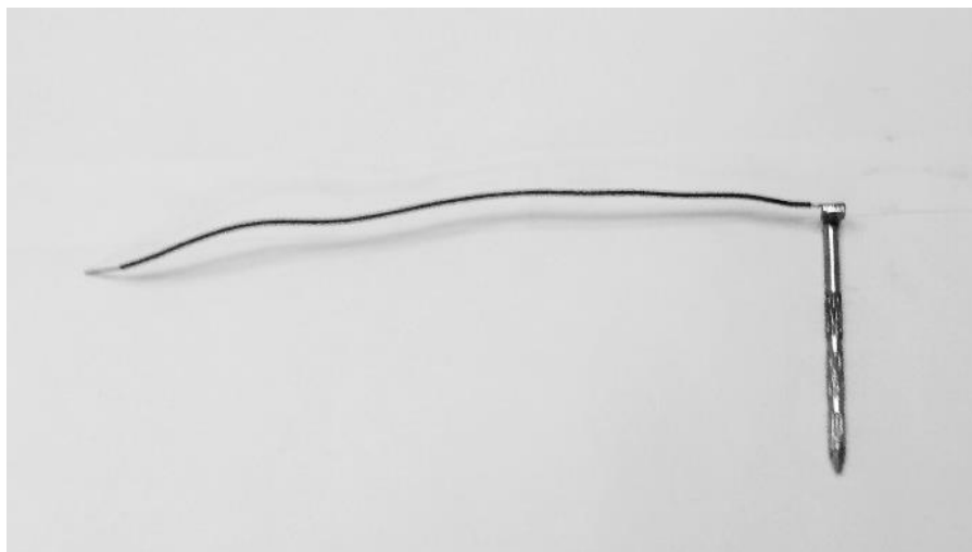
Figura 10: Cátodo acoplado al cable de cobre.
