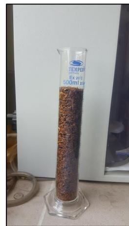
Determinación de densidad aparente mediante método de la probeta
