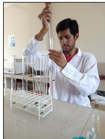
Hidrólisis con ácido sulfúrico 72%
