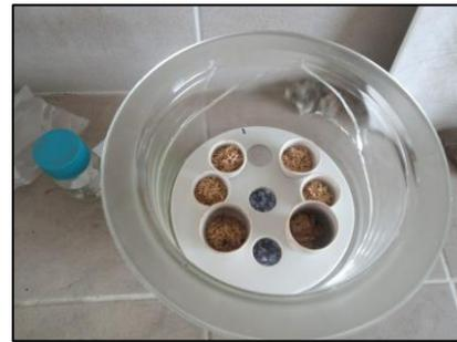
Muestras para prueba de determinación de humedad
