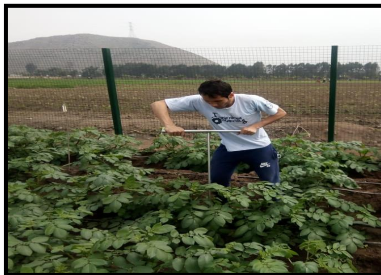
Figura 15: Muestreo del contenido de humedad del suelo. FUENTE: Elaboración propia
