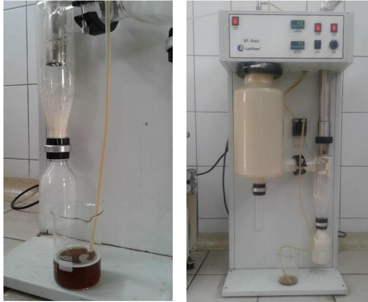
Proceso de atomización del extracto en el equipo modelo SD-Basic, LabPlant
