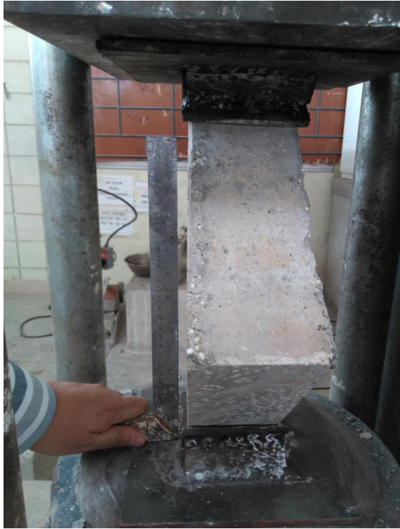
Figura 62: Alineamiento lateral de testigo en ensayo de compresión diagonal
