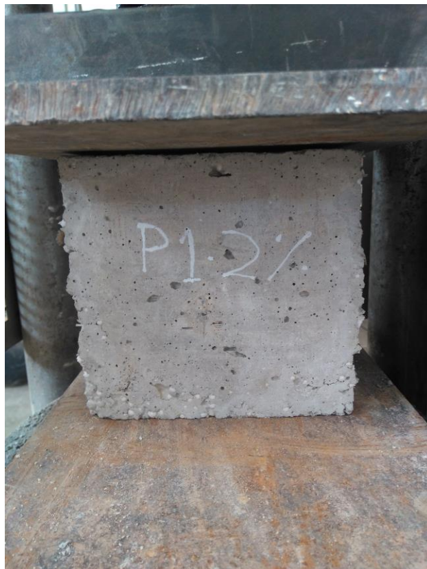
Figura 69: Prueba de compresión axial en probeta de 2% de contenido de fibra
