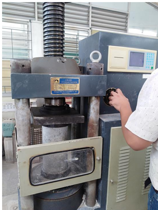
Figura 53: Aplicación de esfuerzo axial a probeta en prensa hidráulica
