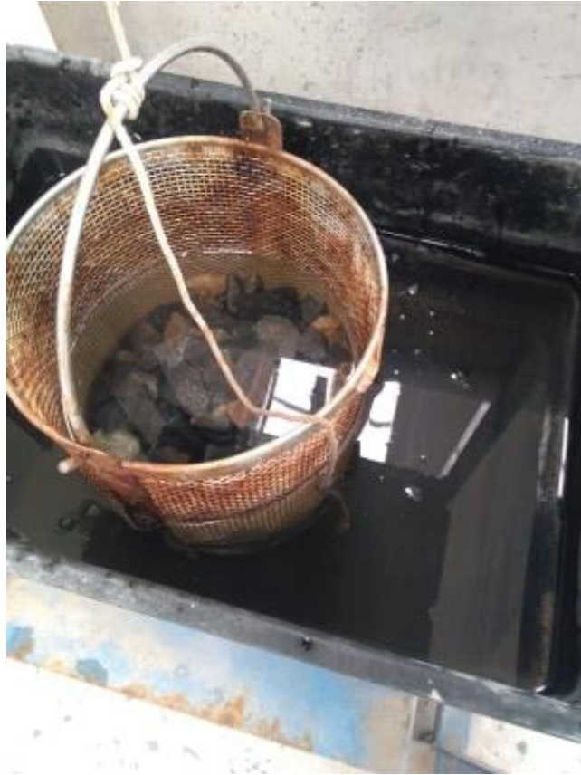
Figura 42: Colocación de agregado grueso en la canastilla de metal
