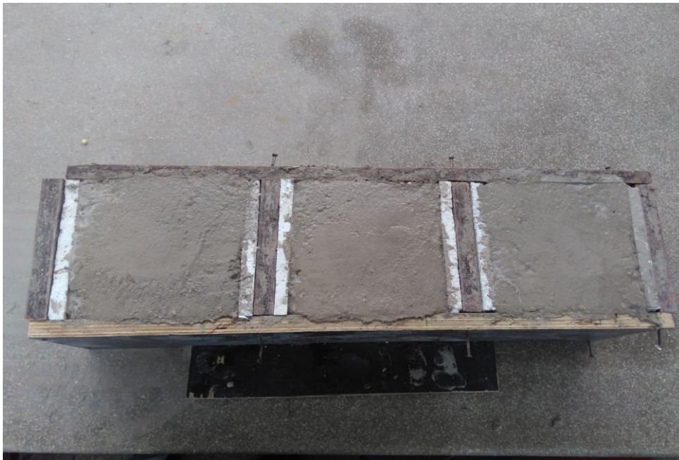
Figura 59: Encofrado y enlucido final de probetas con fibra óptica incorporada
