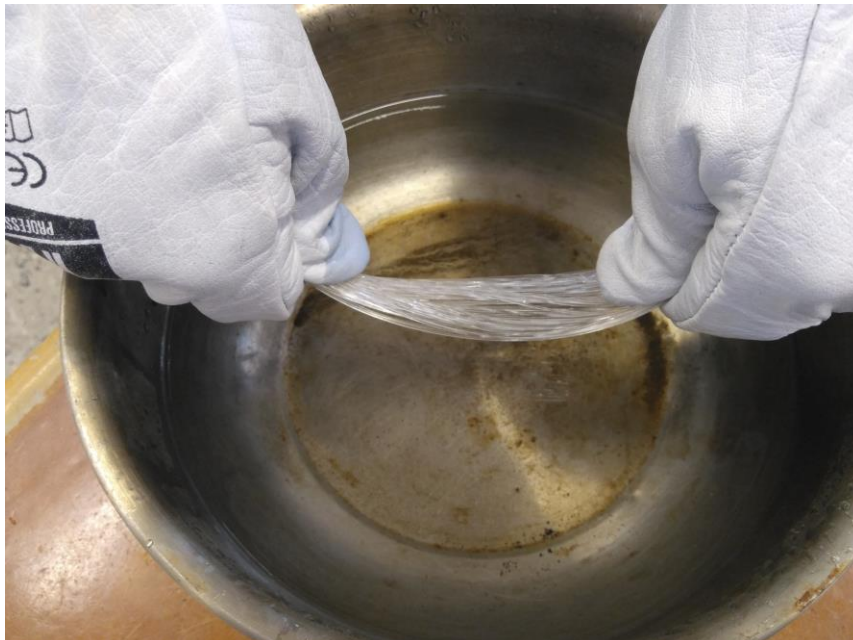
Figura 57: Enderezado de fibra óptica plástica en agua a 80°C
