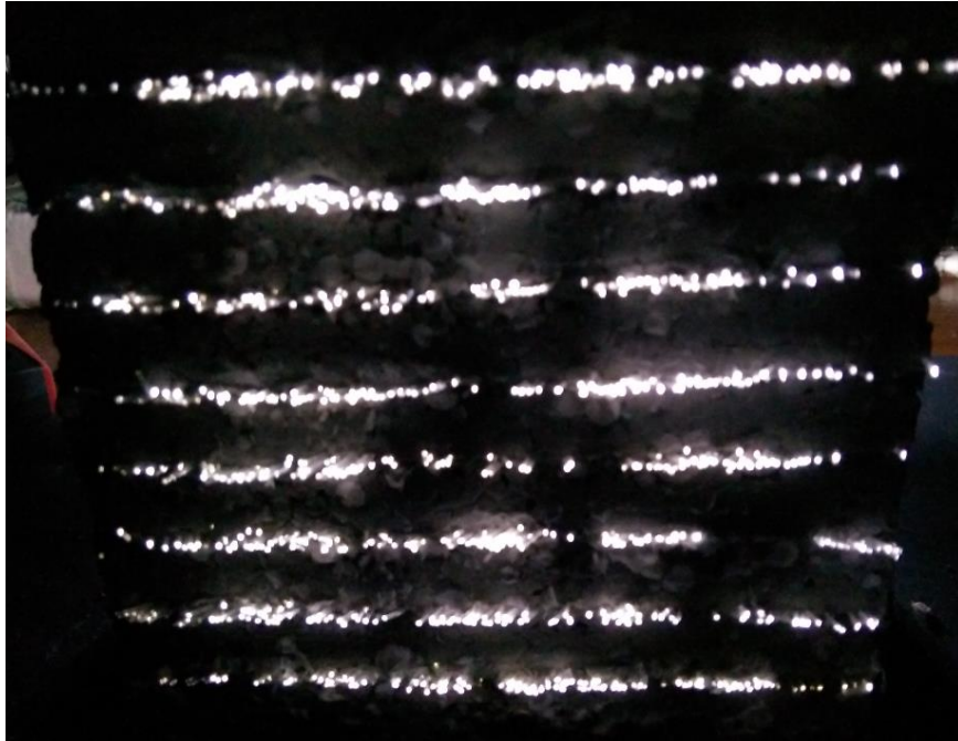
Figura 68: Prueba de traslucidez en probeta con 3% de fibra añadida
