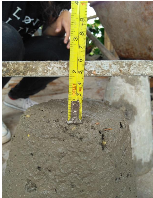
Figura 47: Medición de slump de mezcla húmeda
