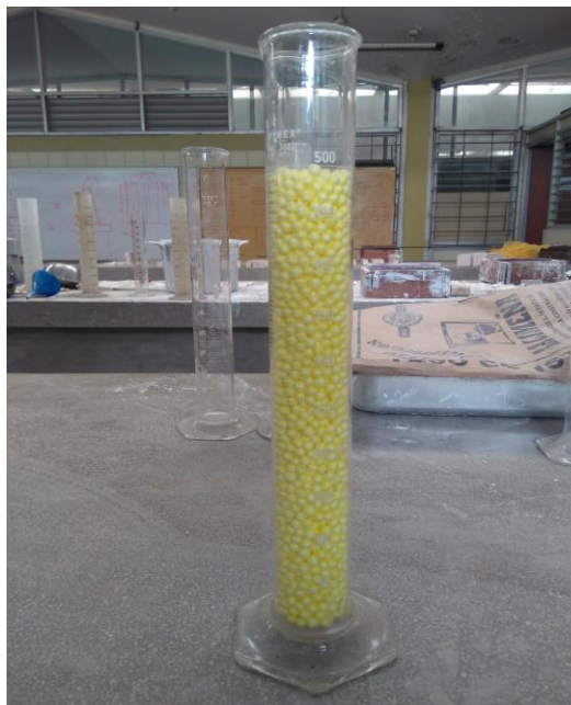
Figura 9: Medición de 500 ml de perlas de EPS para verificación de densidad
