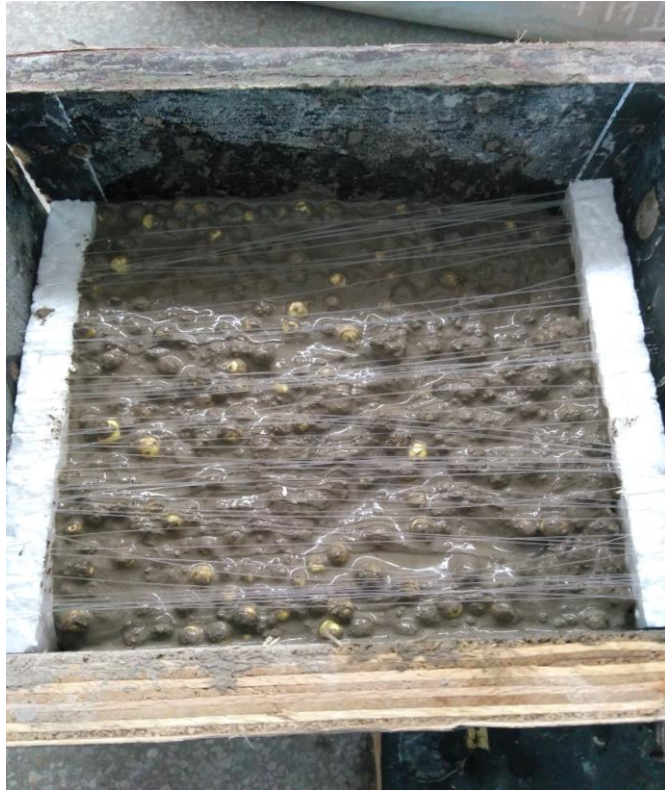
Figura 58: Colocación horizontal de fibra óptica en llenado de probetas cúbicas
