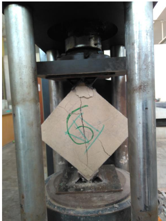
Figura 65: Falla por corte y aplastamiento en testigo 06
