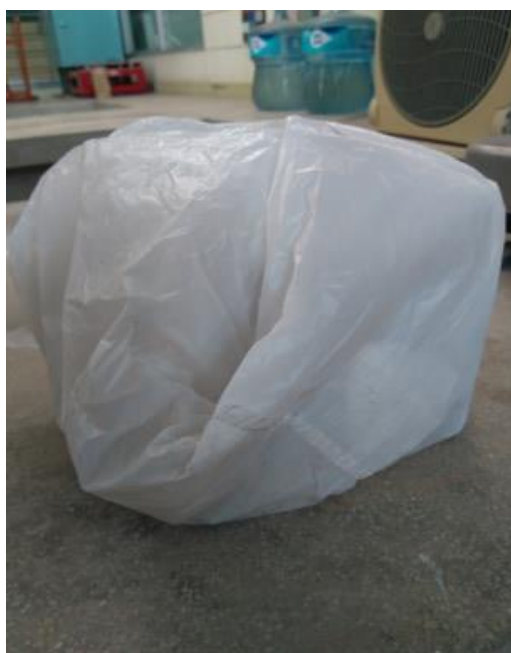
Figura 16: Embolsado y almacenado de probeta de concreto liviano.
