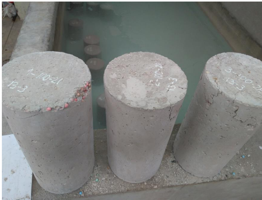
Figura 55: Testigos de concreto liviano sacado ya ensayados
