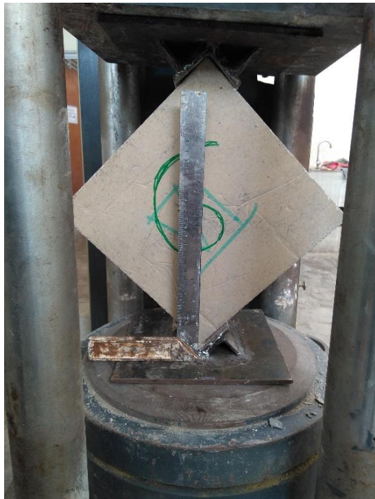
Figura 63: Alineamiento central de testigo en ensayo de compresión diagonal
