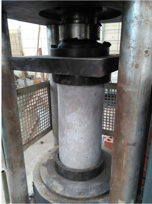
Figura 52: Colocación de testigo en prensa hidráulica para prueba de compresión
