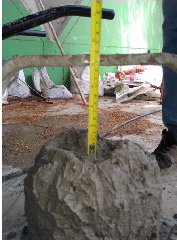
Figura 50: Slump de 5 pulgadas para concreto al 100% de EPS añadido
