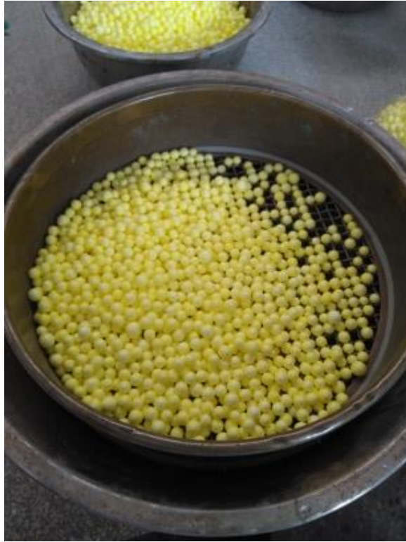
Figura 44: Tamizado de perlas de poliestireno
