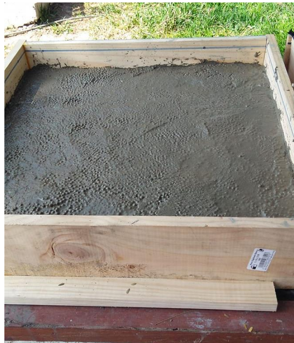
Figura 61: Panel de concreto liviano para prueba de compresión diagonal
