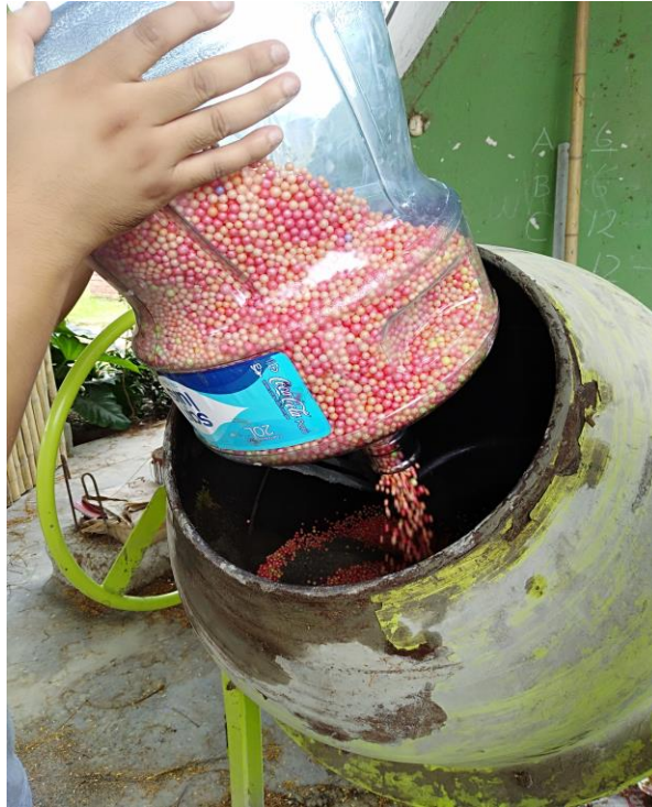
Figura 48: Vertido de perlas en mezcla al 100% de EPS añadido
