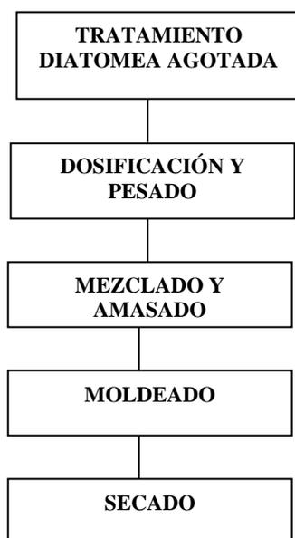
**Figura 7: Diagrama de Bloques del Proceso para elaboración de ladrillos**
