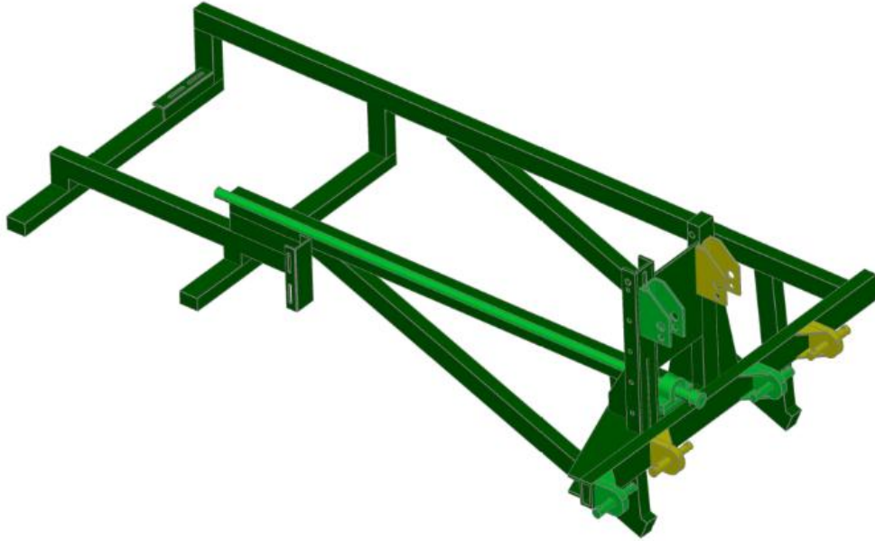
Figura 39: Acoplamiento de los enganches superiores e inferiores de 3 puntos, fijado al chasis de la arrancadora de papa y el acoplamiento de eje toma de fuerza para la transmisión
