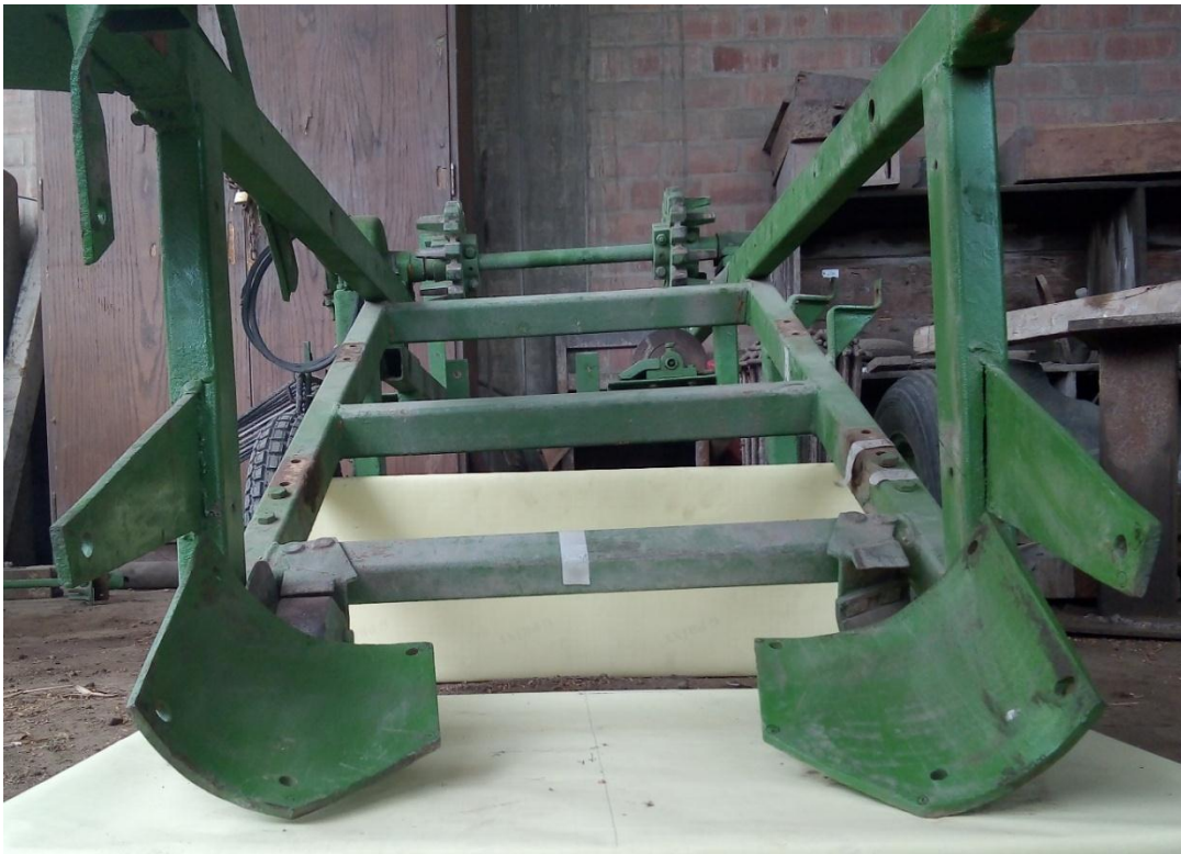
Figura 46:hasis de arrancadora de papas con las planchas soporte para la cuchilla de corte
