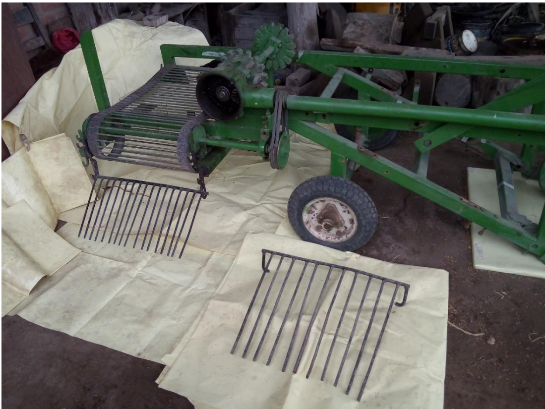
Figura 61: Arrancadora de papas (Esp) con vista a las rejillas seleccionadoras de descarga lateral.
