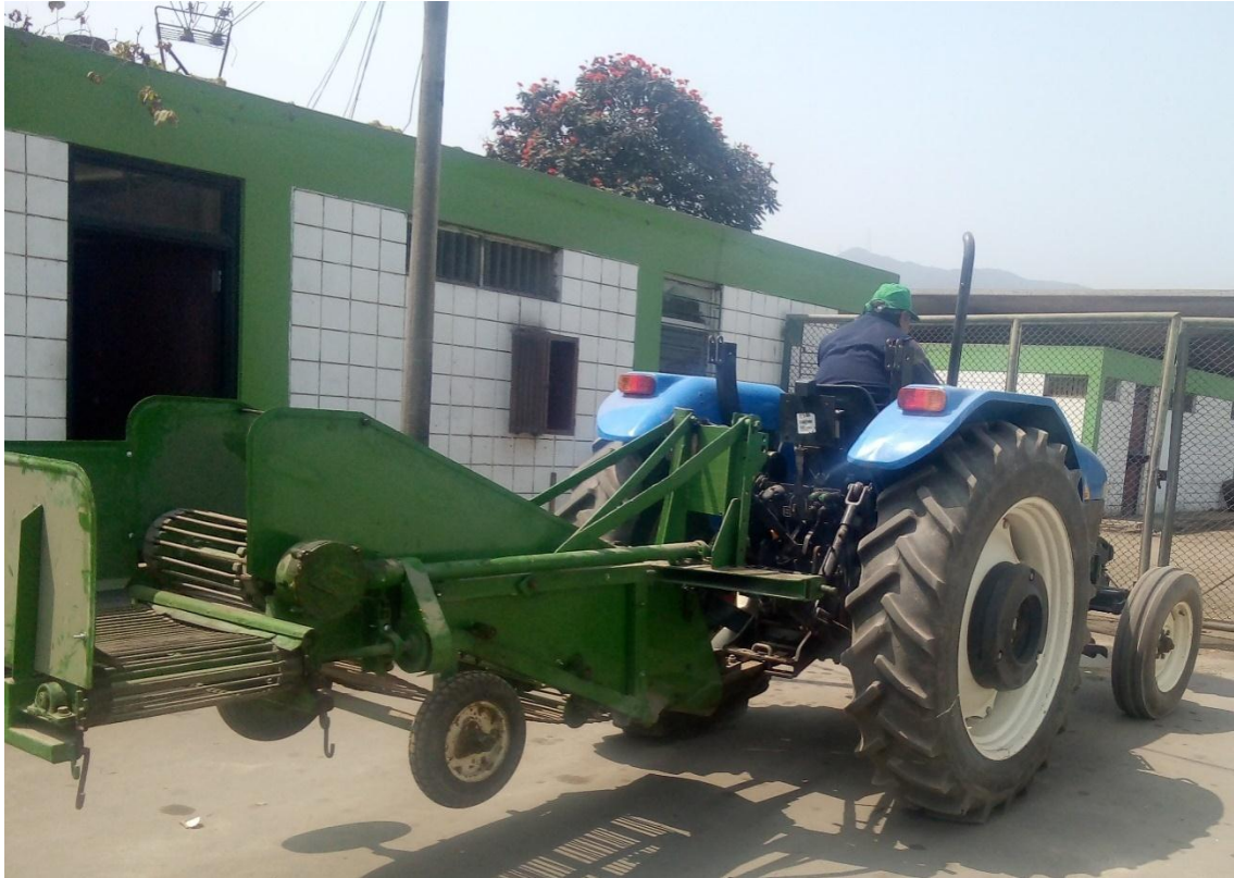
Figura48: Acoplamiento del enganche entre puntos tractor-implemento en posición de transporte.
