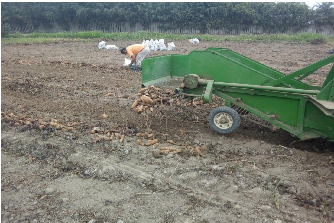
Figura 51:Arrancadora de papas (Esp) cosechando camote, se puede observar la descarga lateral y lineal en el campo del programa de tuberosas de la UNALAM.
