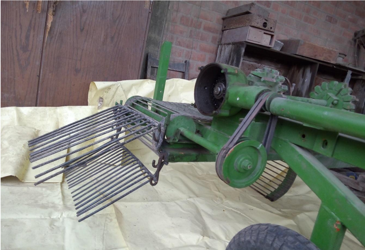
Figura 62:Arrancadora de papas (Esp) con rejillas de descarga lateral instaladas.
