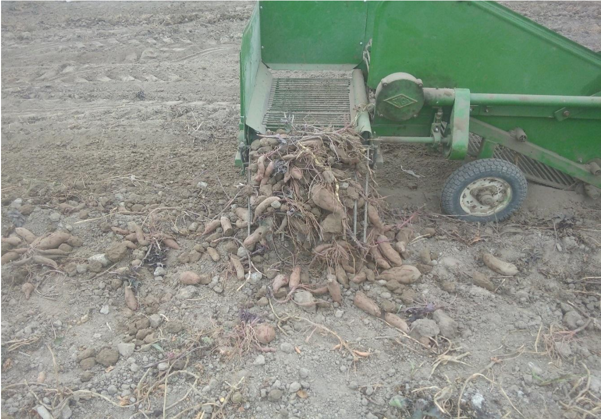
Figura 50:Arrancadora de papas (Esp) cosechando camote. Se puede observar la caída de descarga lateral utilizando las rejillas seleccionadoras.
