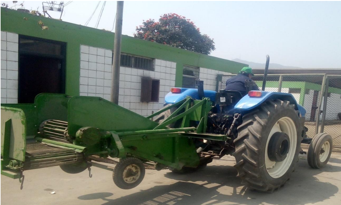
Figura 49: Arrancadora de papas (Esp) suspendida en el enganche de tres puntos al tractor agrícola durante su traslación hacia el campo de cosecha.
