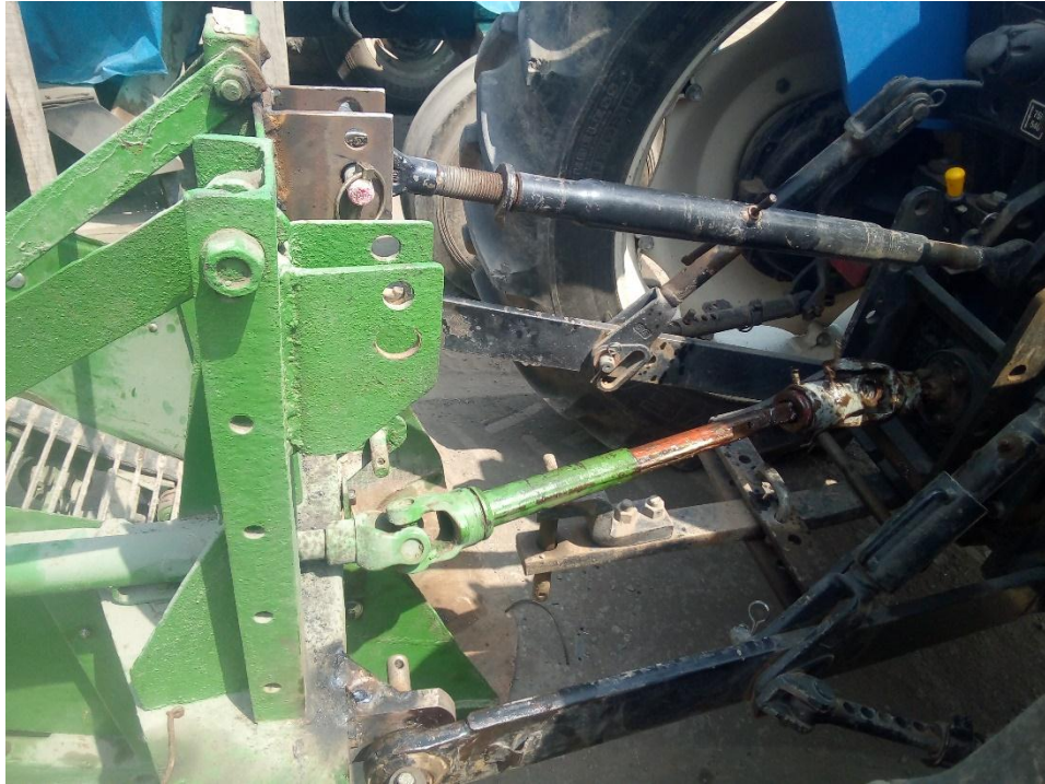
Figura 41: Acoplamiento del enganche entre puntos tractor-implemento en vista lateral
