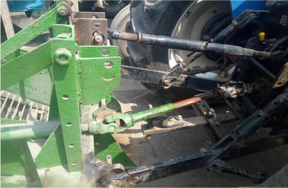
Figura 48: Arrancadora de papa (Esp) acoplada en el enganche de tres puntos y cardán con el tractor agrícola en una de sus alternativas de acople.
