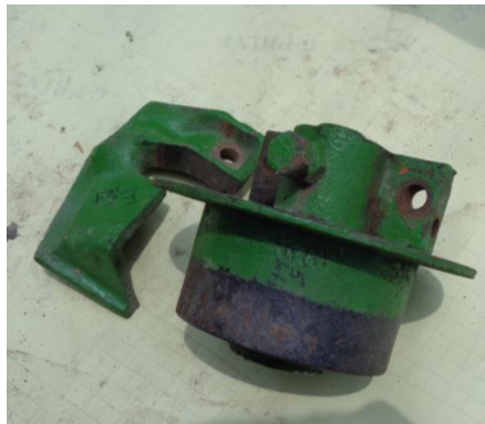
Figura 26: Mecanismo templador de cadena de descarga lateral.
