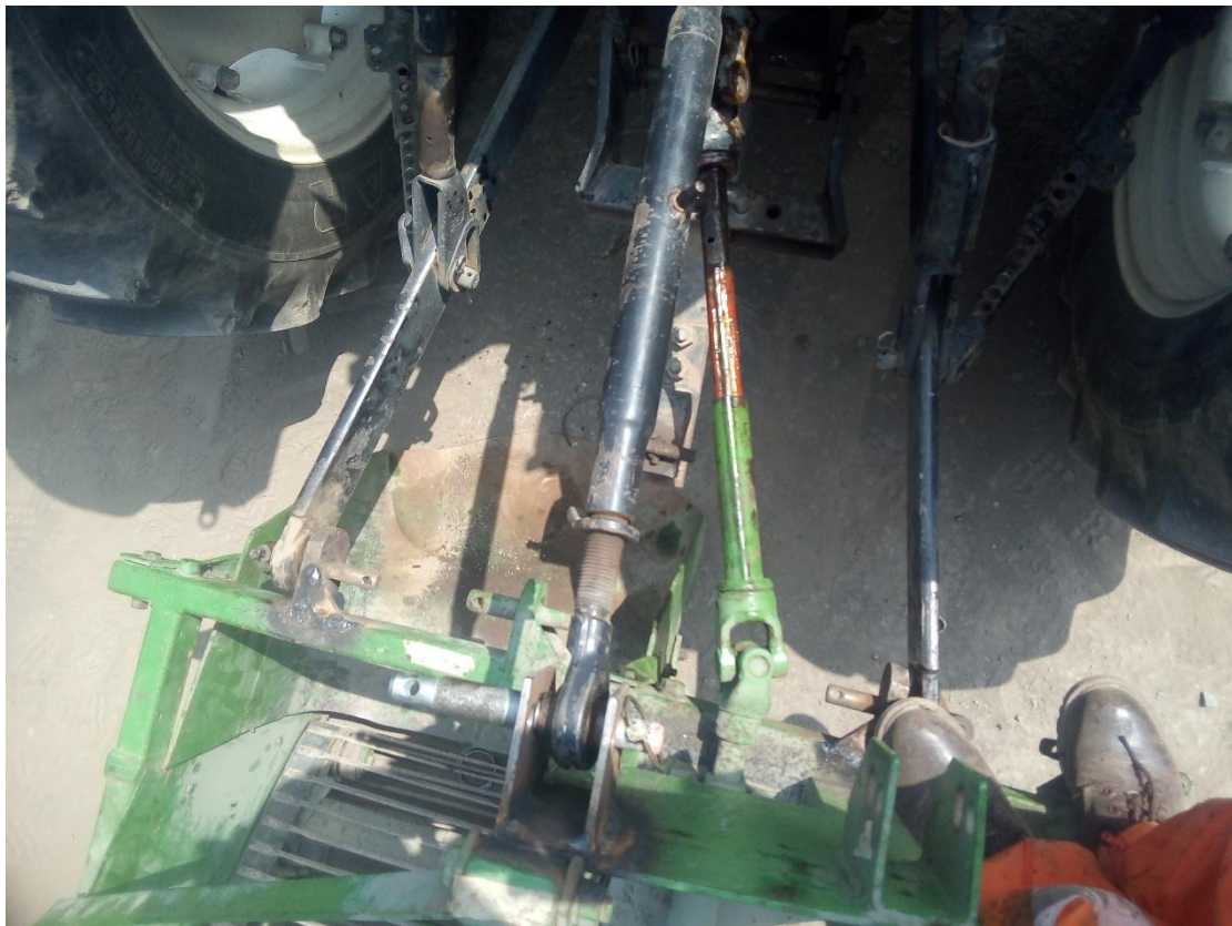
Figura 42: Acoplamiento del enganche entre puntos tractor-implemento en vista de arriba
