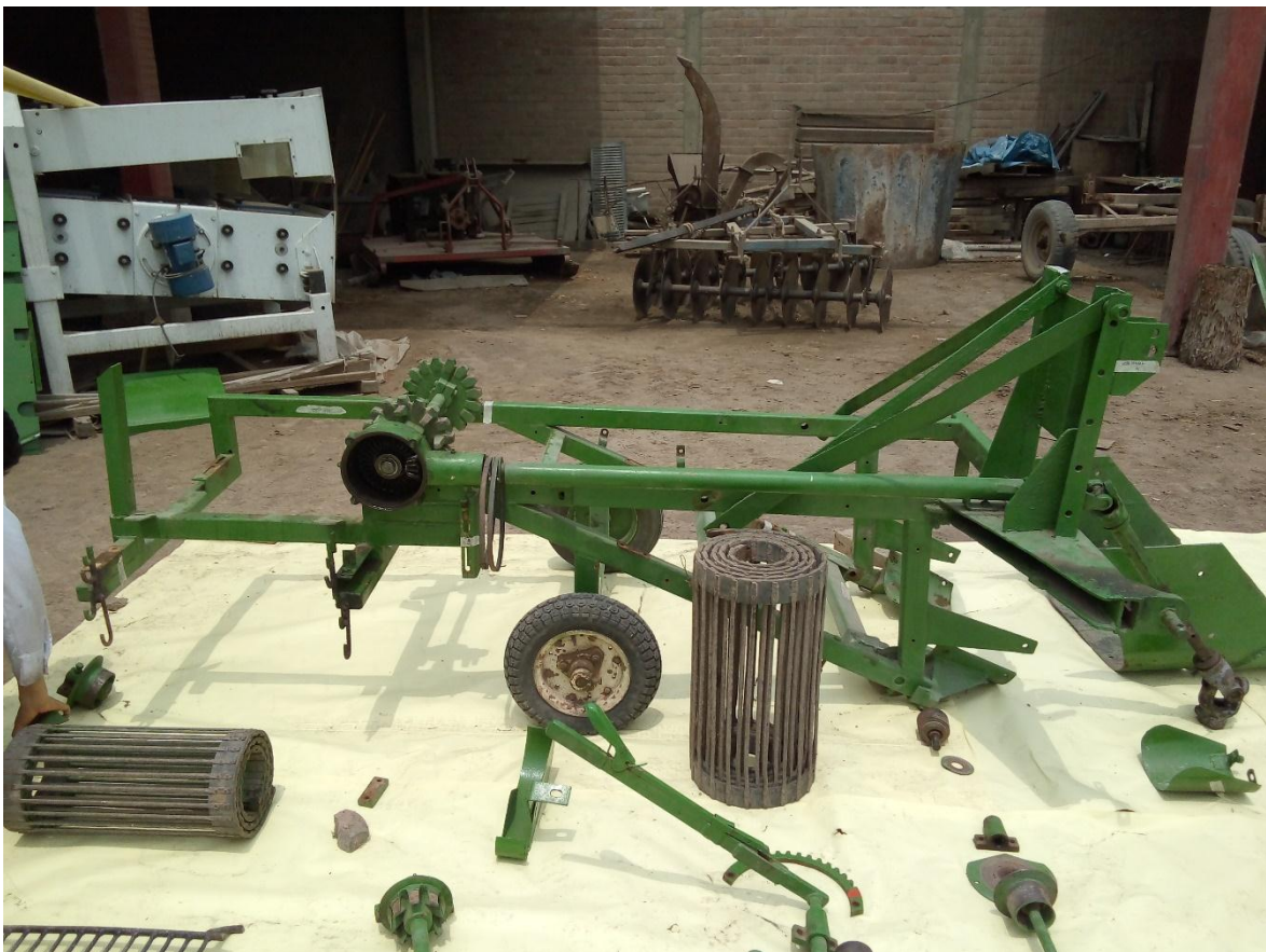
Figura 59: Arrancadora de papas con todos sus componentes desarmados en el taller del fundo-UNALAM. Observándose las dos cadenas: la zarandeadora y la de descarga lateral.
