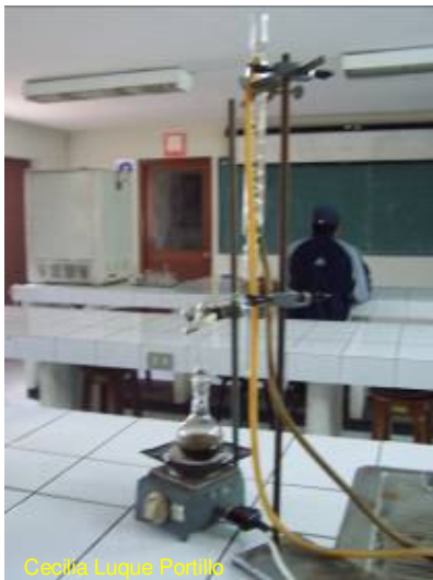
Figura 5. Ensayo Humedad Azeotrópica con Trampa Dean Stark – H_{Fr} .
