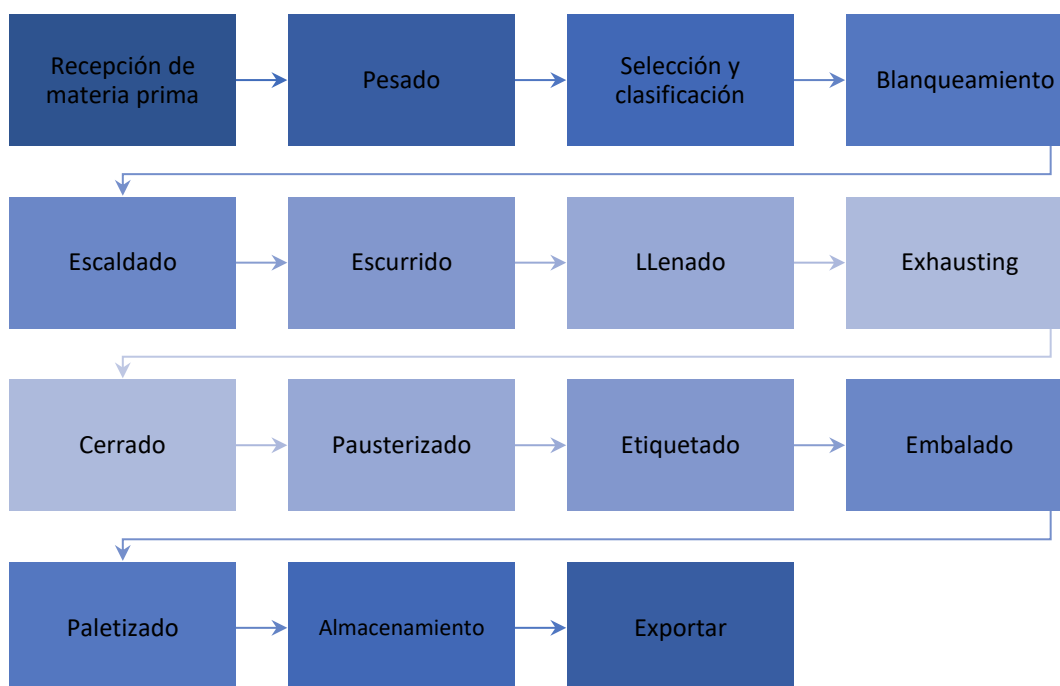
Figura 7: Proceso de producción de alcachofa en conserva
