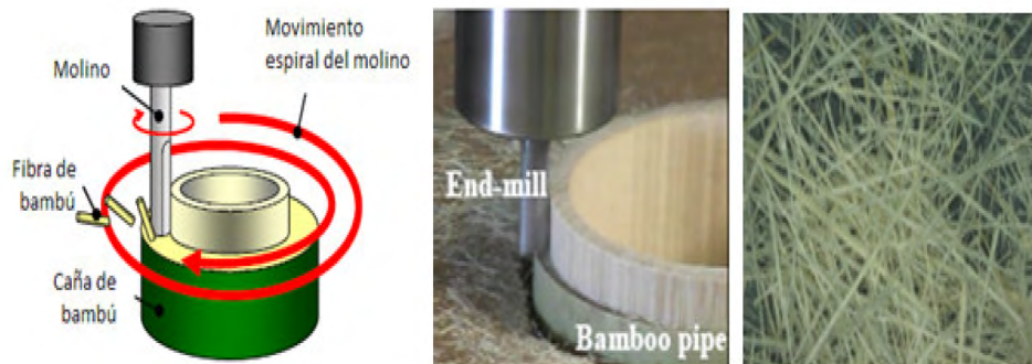
Figura 4. Sistema de desfibrado en espiral. (Ogawa et al , 2008).
