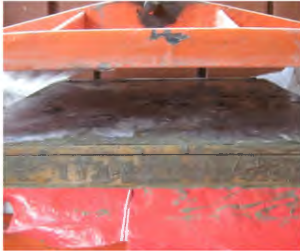
Figura 13. Prensado de moldes tableros de ensayo (Foto: A. Espinoza)
