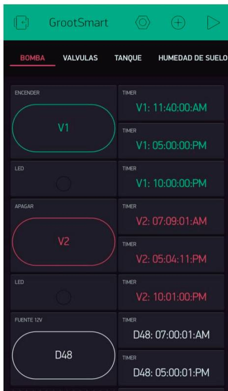
**Figura 49: Menú para el control de la bomba y fuente de 12v**
