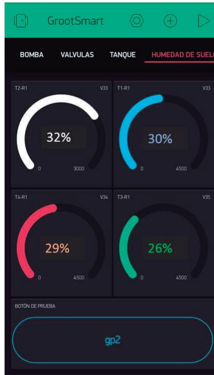
**Figura 52: Menú para el monitoreo del sensor de humedad de suelo**
