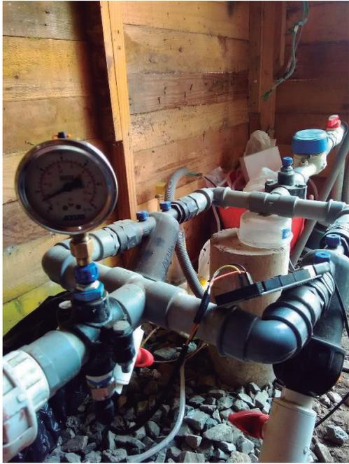
**Figura 132: Calibración del sensor de presión**
