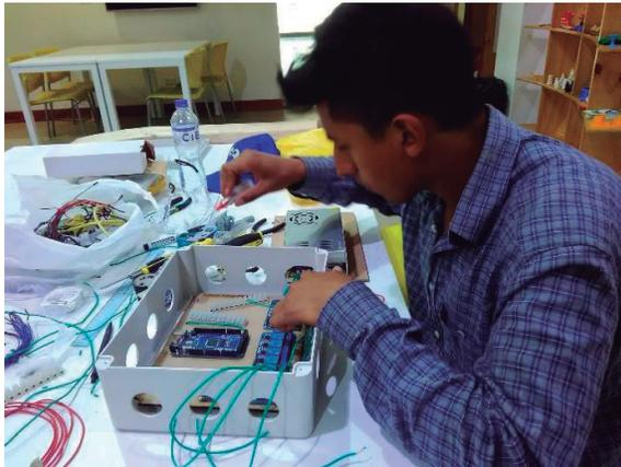
**Figura 117: Elaboración de controlador de riego**
