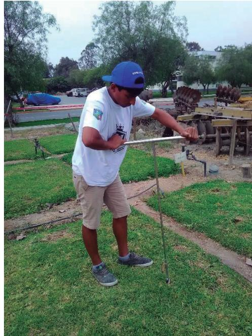
**Figura 128:** Extracción de suelos para método gravimétrico
