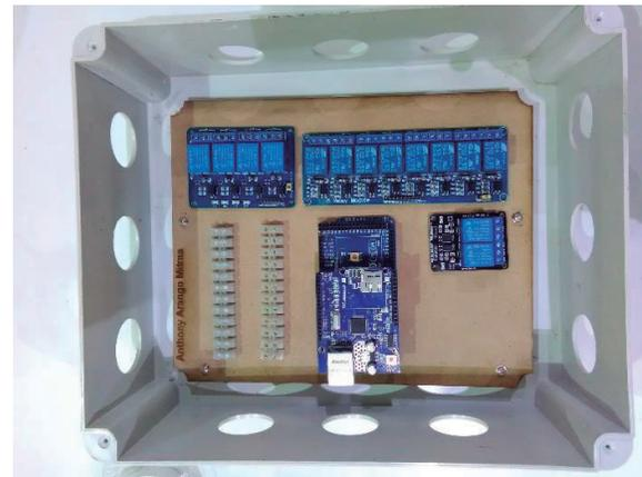
**Figura 120: Integración de placas en el controlador**
