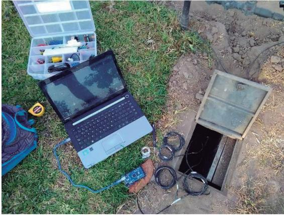
**Figura 124: Calibración de sensores de humedad de suelo**
