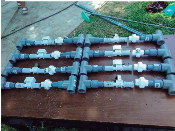
**Figura 119: Arco de riego automatizado**
