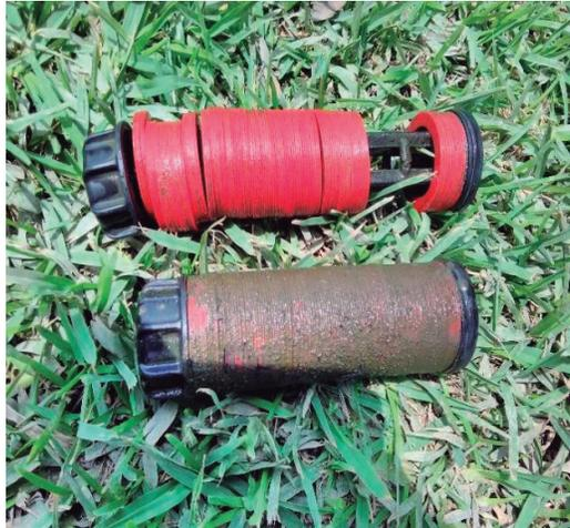
**Figura 107: Filtro de anillas antes y después de limpieza**
