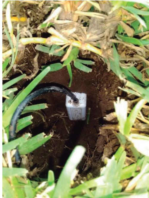
**Figura 144: instalación de sensor de humedad de suelo**
