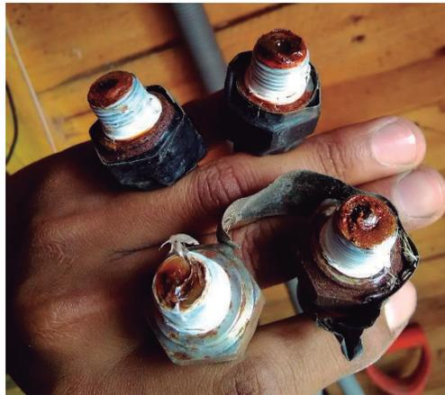
**Figura 105: Sensores de presión sin mantenimiento**
