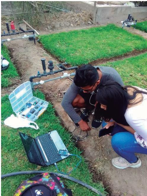
**Figura 130:** Calibración de sensores de humedad con datalogger EM -50G
