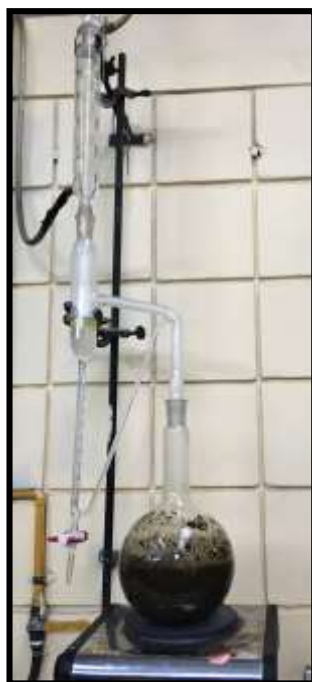
Figura 4: Hidrodestilador con equipo Clevenger
