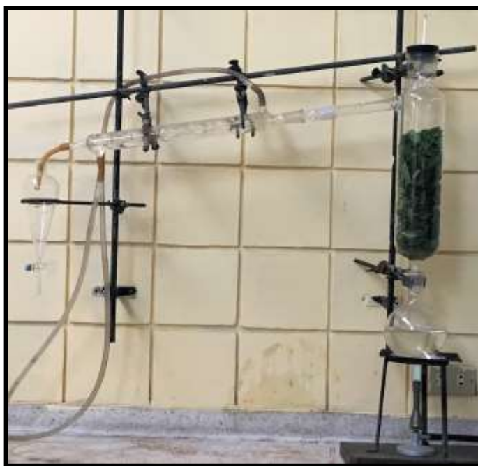
Figura 3: Destilador por arrastre de vapor de agua
