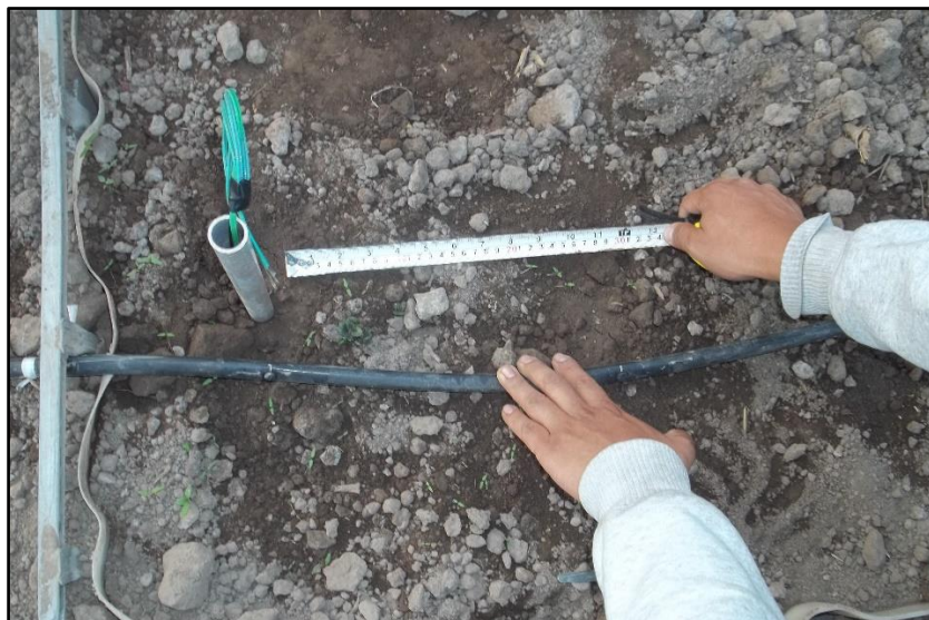
Figura 19: Instalación del sensor Watermark
