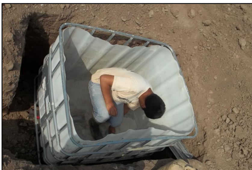
Figura 14: Tanque utilizado para la construcción del lisímetro
