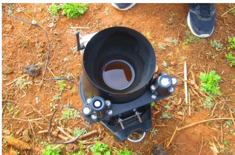
**Figura 57: Acumulación de sedimento en la estación Cruzpampa**
