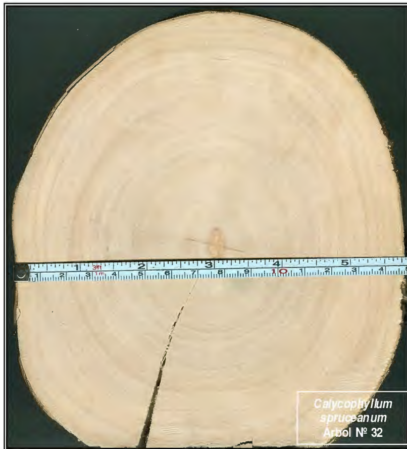
Figura 9 : Sección transversal de una troza en estudio de Calycophyllum spruceanum
