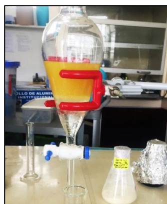
Imagen 4: Extracción de alcaloides con en pera de decantación.
