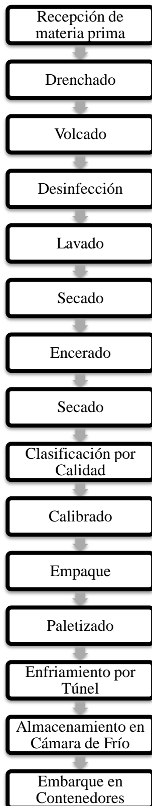
Figura 6. Flujograma del proceso poscosecha de procesadora de Huaral. Determinación de la efectividad de los tratamientos en las etapas de drenchado, desinfección y encerado en el proceso de fruta cítrica para exportación en procesadora – campaña 2012. Jorge Luis Tamayo Diaz. Comunicación directa.
