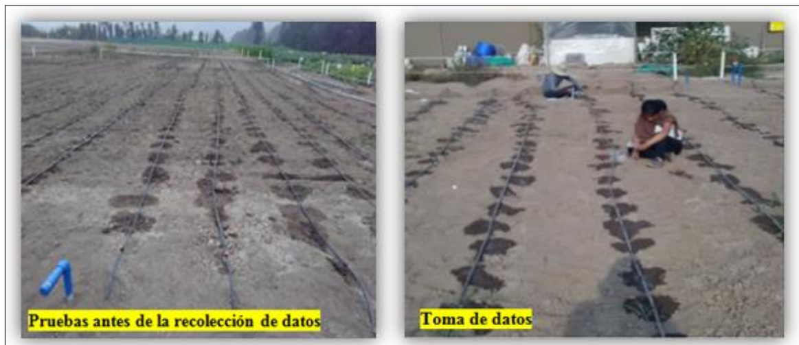
Figura 25: Evaluación del C.U de las subunidades sin ningún equipo de inyección
