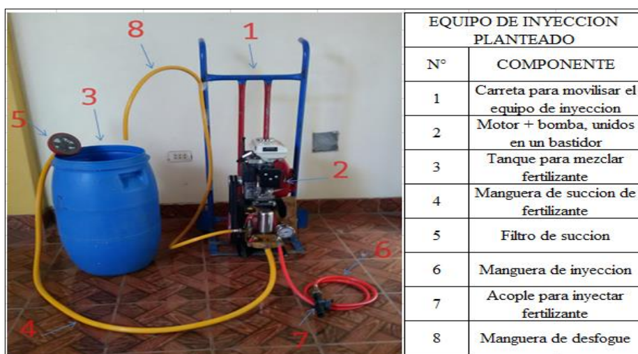
Figura 22: Equipo de inyección armado
