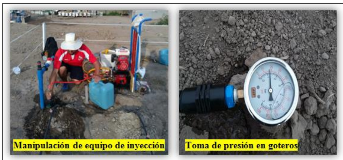
Figura 26: Evaluación del C.U en las subunidades usando el equipo de inyección
