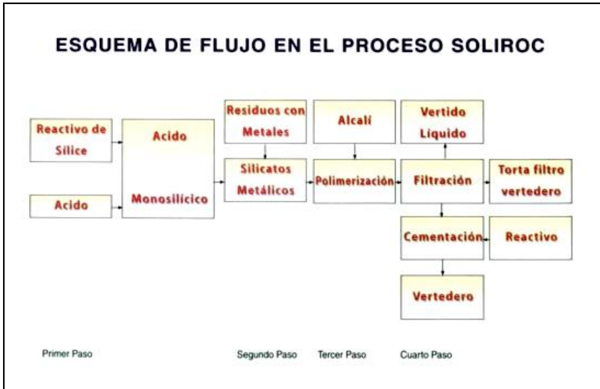
Figura 28: Esquema de flujo en el proceso Soliroc.
