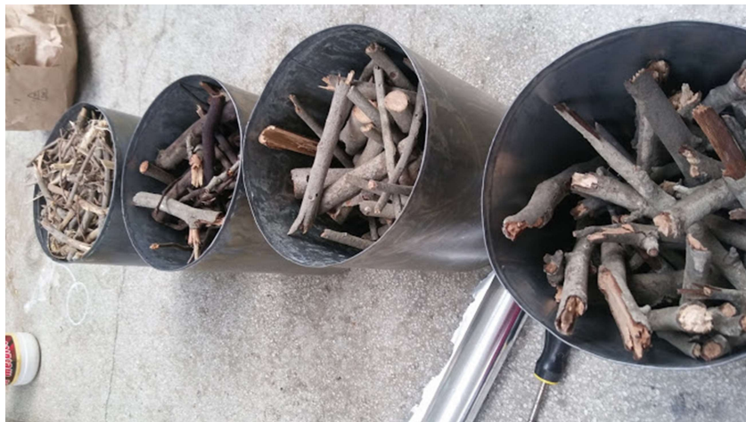
Figura 10: Preparación de muestras en recipientes resistentes a la temperatura, para su ingreso a horno pirolítico.
