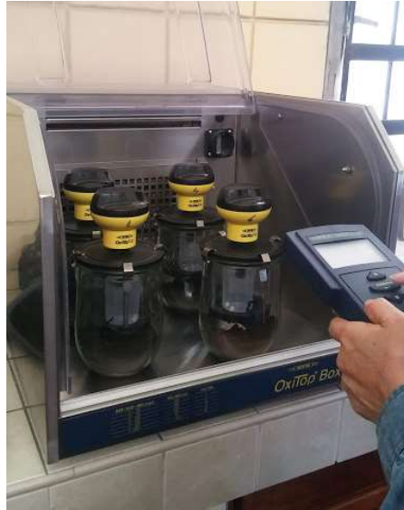
Figura 25: Instalación de prueba de Oxitop para muestras de biochar en estudio.
