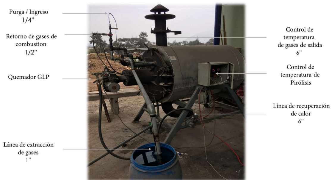
Figura 11: Horno pirolítico utilizado para la producción de biochar . (Diametros de tubería en pulgadas)
