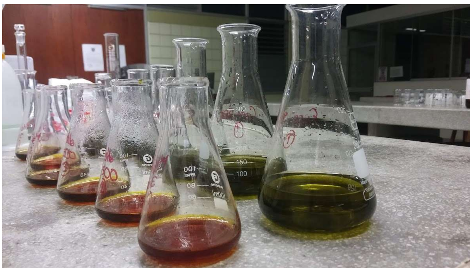
Figura 21: Oxidación de carbono con K_2Cr_7O_2 y posterior titulación con tiosulfato ferroso e indicador de difenilamina.
