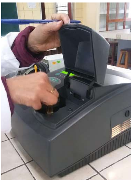
Figura 20: Determinación de K_2Cr_2O_7 que no ha reaccionado con el carbono soluble.
