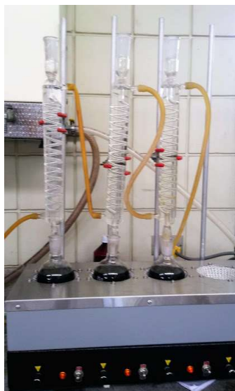
Figura 23: Hidrólisis con ácido sulfúrico (H 2 SO 4 ) en condensador a reflujo.
