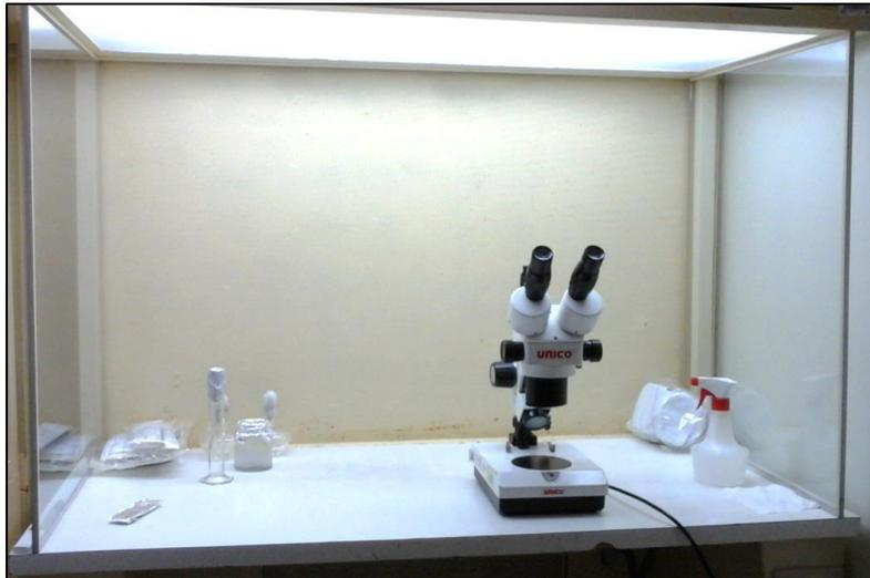
**Figura 13: Cámara de flujo laminar con materiales para siembra**
