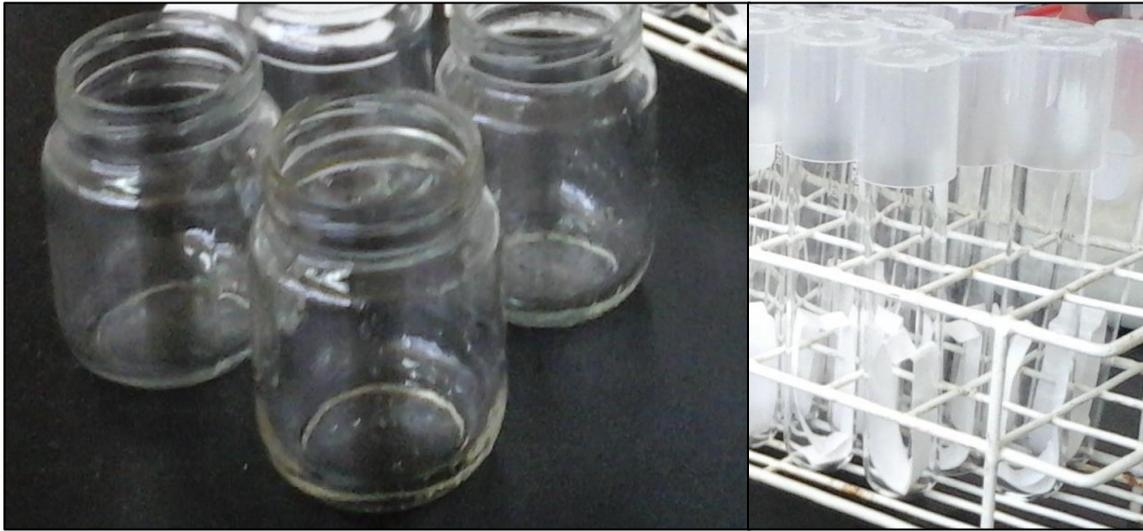
**Figura 9: Frasco para siembra en medio sólido (izquierda) y tubos para medio líquido con el papel filtro en forma de “puente” (derecha)**
