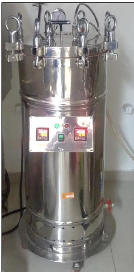
**Figura 12: Autoclave: equipo de esterilización por calor húmedo**
