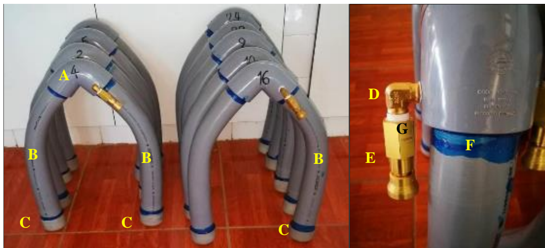
Figura 8: Componentes del cánisters para colección de muestras de gases
