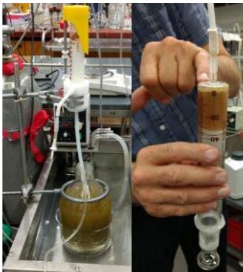
Figura 3: Técnica in vitro de producción de gases y emisión de metano entérico de Hohenheim (Hohenheim Gas Test) descrito por Menke y Steingass (1988). FUENTE: Alvarado (2018).
