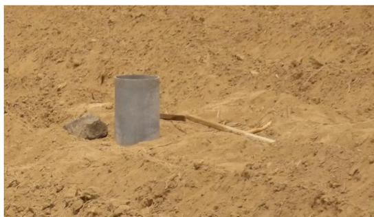
**Figura 4: Instalación de cilindros infiltrometros.**
