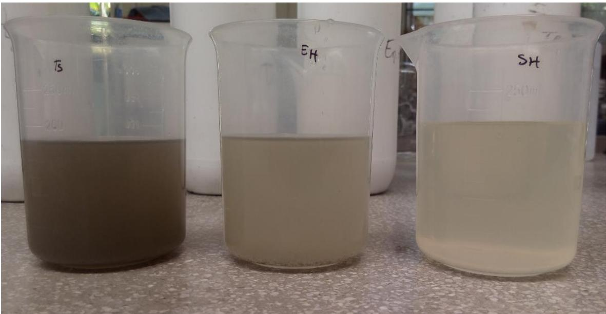
**Anexo 7.10: Vista de turbiedad de las muestras (Afluente, salida del tanque séptico y salida del humedal)**
