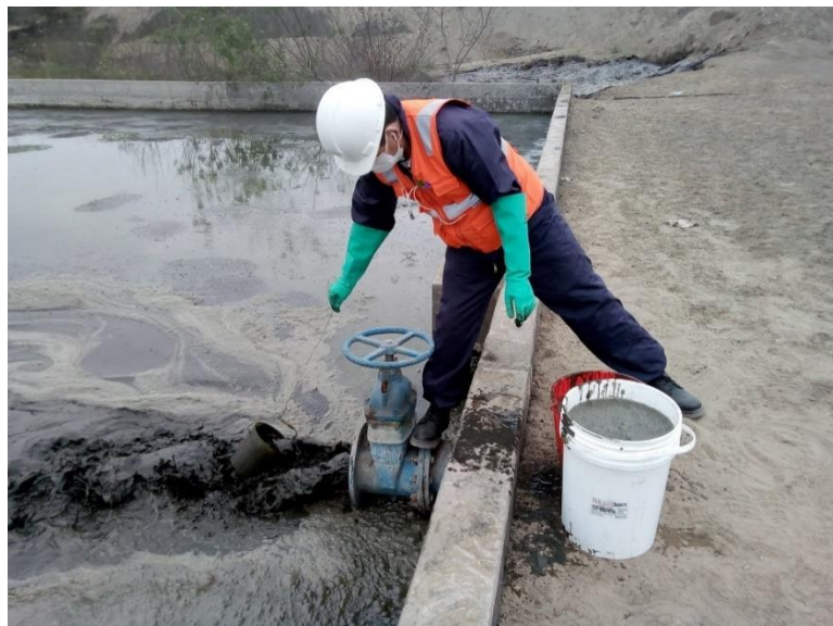
Figura 14: Toma de muestra en la válvula de escape de la laguna anaerobia de la PTAR Huáscar
