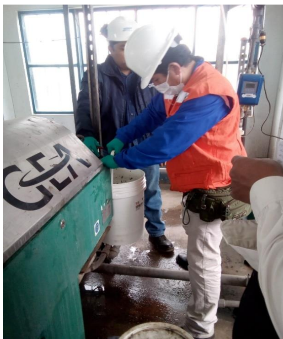
Figura 20: Toma de muestra de la válvula del espesador de la PTAR Santa Clara
