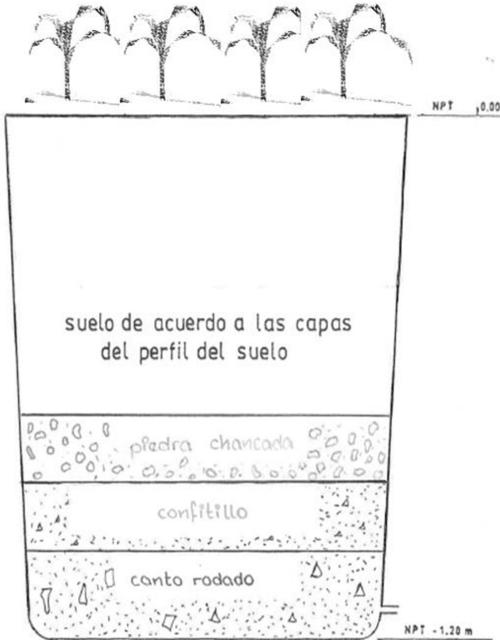
**Figura 3: Perfil vertical del contenido sólido del lisímetro.**
