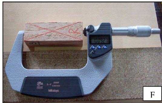
E. Medición con micrómetro digital de lados, F. Medición con micrometro digital de longitud.
