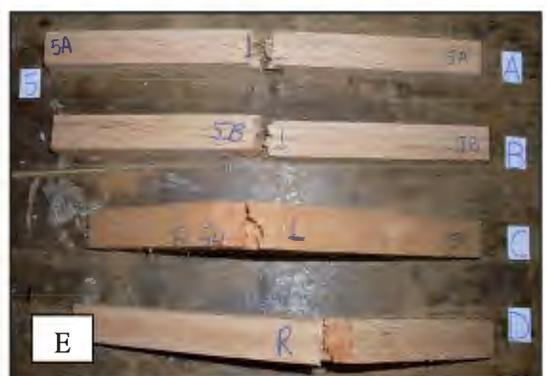
A: Probetas codificadas y orientadas para ensayo. B. Probeta lista para ensayo. C. Resultado de la probeta fallada, D. Probetas con falla astilladura para un solo código, E. Probetas con falla quebradura con falla quebradura para un solo código.
