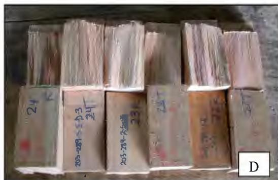
A y B. Probeta en ensayo de clivaje, C. Serie de probetas con falla, D. Visualización de las fallas en las probetas.
