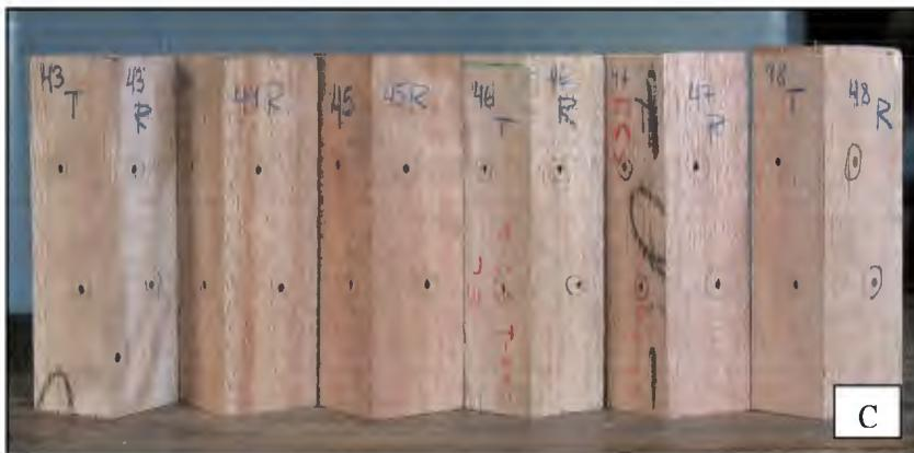
A. Probeta con clavos en posición para ser ensayada, B. Extracción de clavos en sección tangencial, C. Serie de probetas ensayadas en secciones radial y tangencial.
