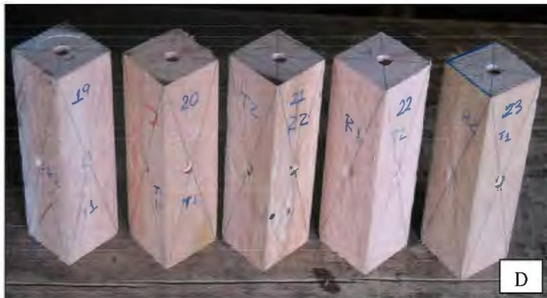
A. Probeta ensayada en sección tangencial, B. Probeta ensayada en extremos, C. Probeta ya ensayada en todas sus secciones, D. Serie de probetas ensayadas.
