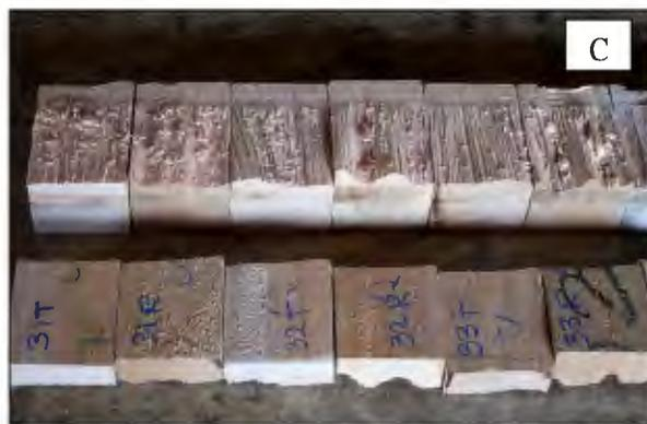
A. Probeta en ensayo de cizallamiento, B. Serie de probetas ensayadas y falladas, C. Visualización de las fallas en las probetas.
