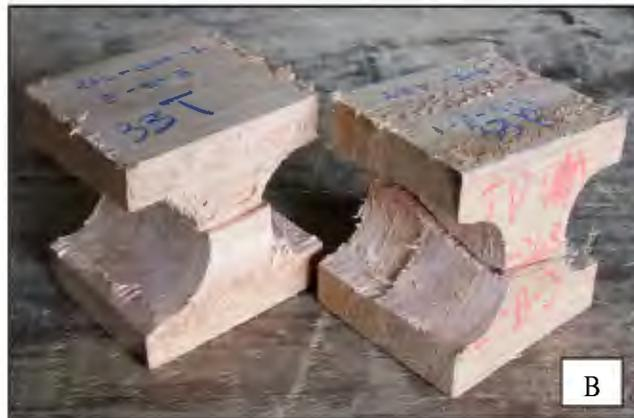
A. Probeta en ensayo, B. Probetas con falla en sección radial y tangencial para un mismo código.
