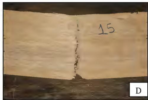
A. Ensayo de flexión estática, B. Probeta a punto de fallar, C. Probeta con falla astilladura, D. Probeta con falla quebradura.
