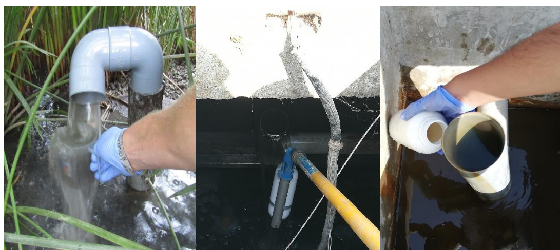
Figura 7: Toma de muestras: Izquierda: afluente de la 1 ra etapa (celda francesa); Medio: efluente de la 1 ra etapa (celda francesa); Derecha: efluente 2 da etapa (humedal subsuperficial de flujo vertical)
