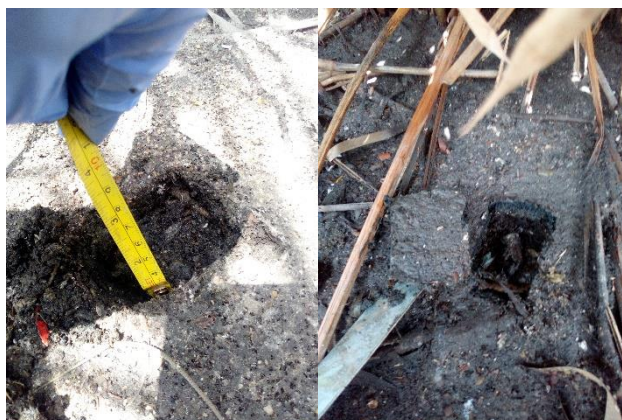
Figura 9: Lodo generado sobre la línea 1 y 2 de la 1 ra etapa del Sistema Francés. Izquierda: evaluación de acumulación de lodo; Derecha: toma de muestra de lodo
