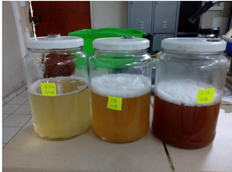
Foto 6: Dispersiones de goma de sapote mas quitosano listas para ser usadas
