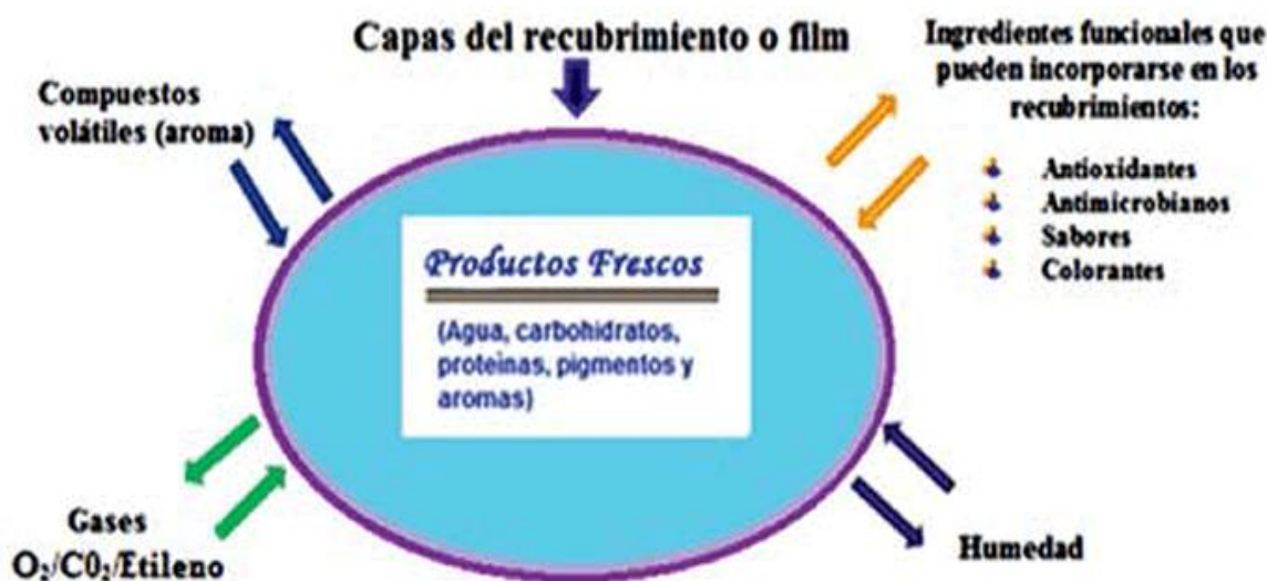
Figura 4: Transferencias que pueden ser controladas por recubrimientos comestibles
