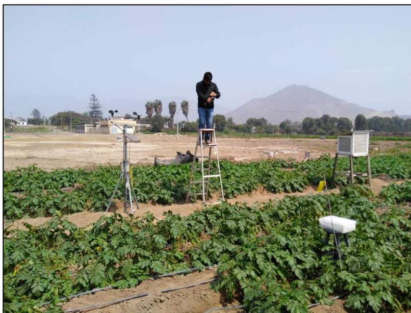
Figura 19: Posicionamiento adecuado de la cámara térmica.
