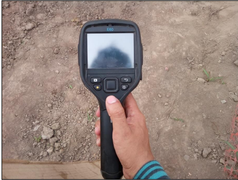
Figura 16: Cámara térmica FLIR E60 utilizada en campo.
