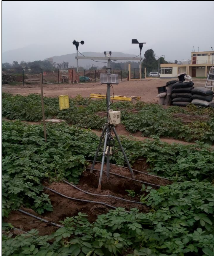
Figura 20: Estación meteorológica automática HOBO situado en el centro del campo experimental.
