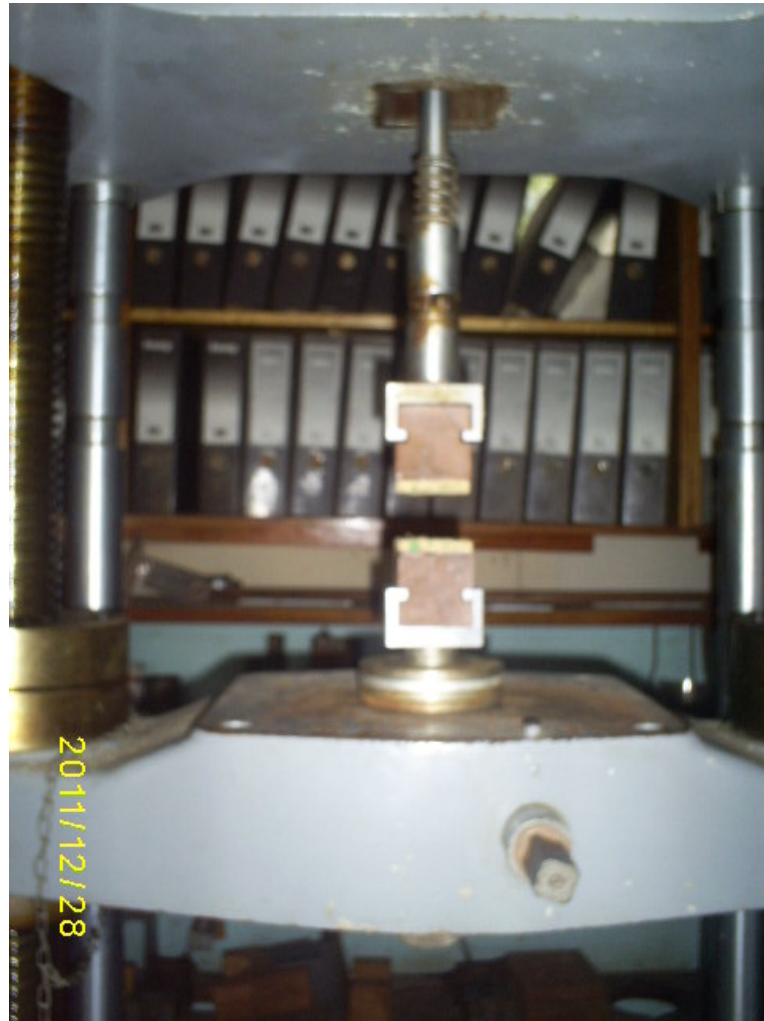
Figura 7 Ensayo de tracción perpendicular
