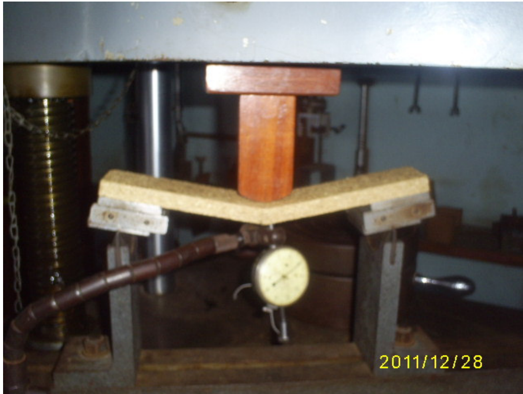
Figura 6 Ensayo de flexión
