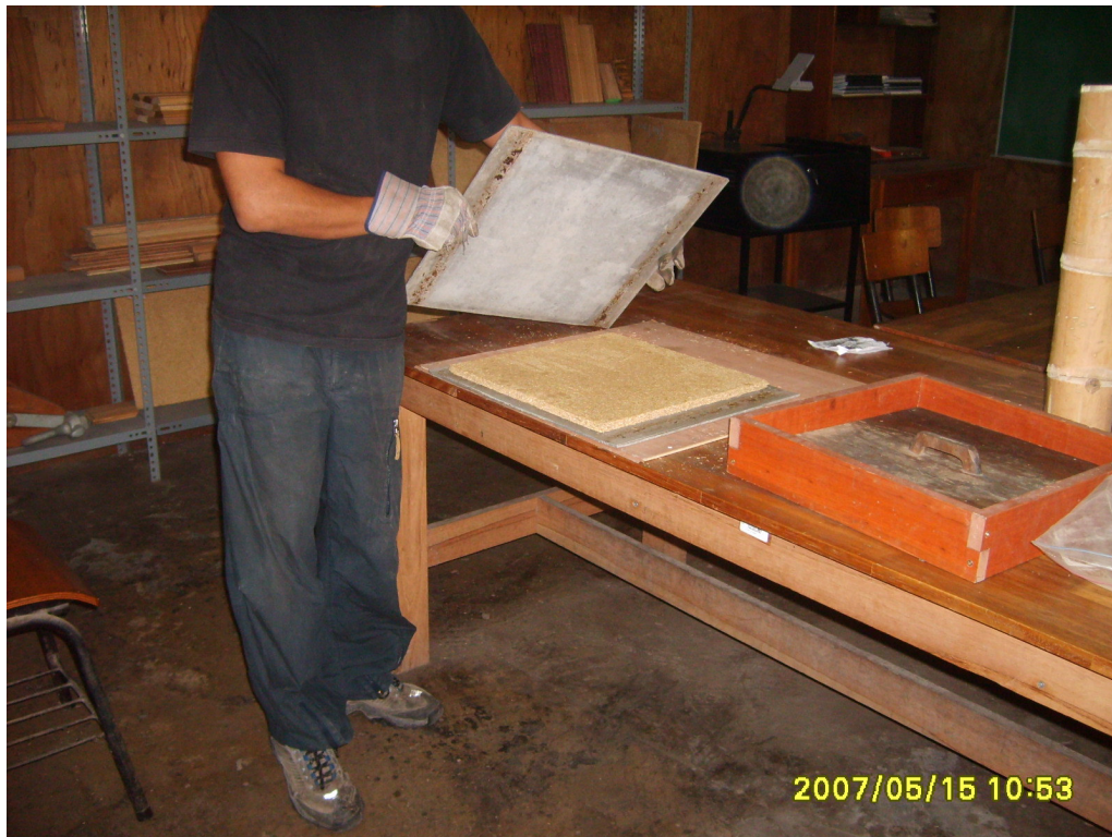
Figura 5 Tablero final después del prensado
