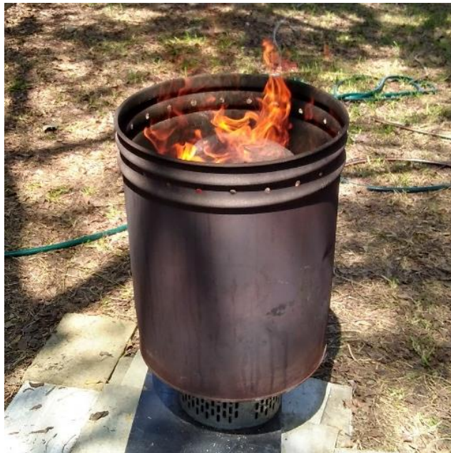
Figura 10: Puesta en marcha del proceso de pirólisis. Fuente: Elaboración propia
