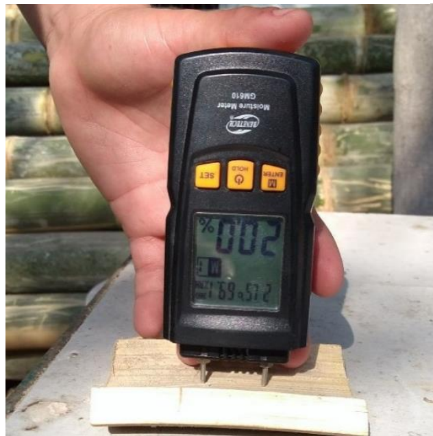
Figura 6: Medida del contenido de humedad interno. Fuente: Elaboración propia
