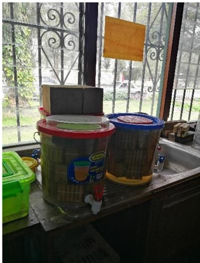
Saturación de probetas
