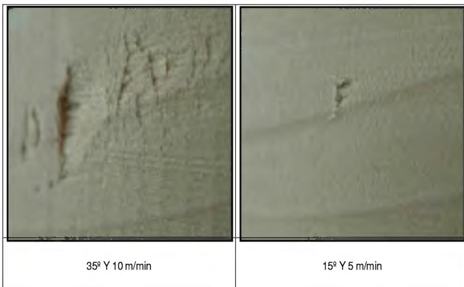
FOTO N° 3: SUPERFICIE DE PROBETA DE CAPIRONA
