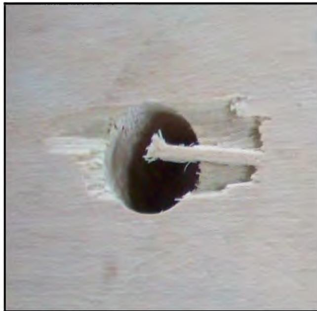
FOTO N° 8: RUPTURA DE GRANO, (ORIFICIO DE SALIDA).
