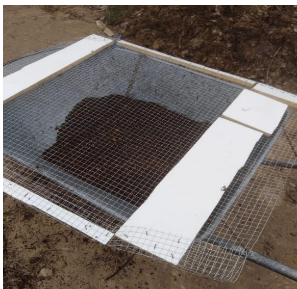
Figura 19: Tamizado de biopilas
