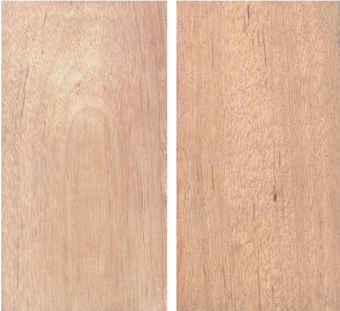
Figura 12 Madera en corte tangencial y radial de Dacryodes nitens .
