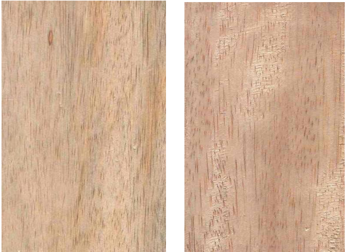
Figura 2 Madera en corte tangencial y radial de Anacardium giganteum .
