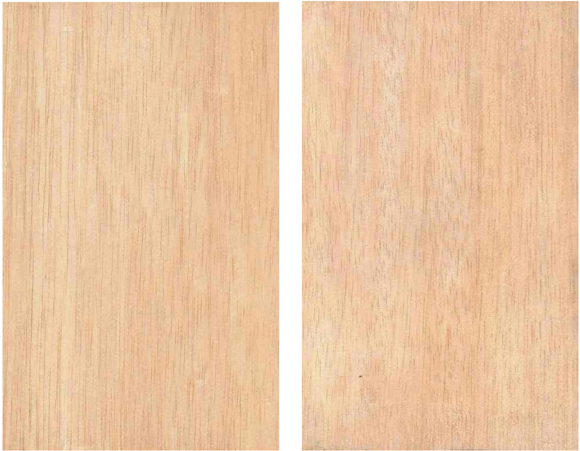
Figura 27 Madera en corte tangencial y radial de Mollia lepidota .
