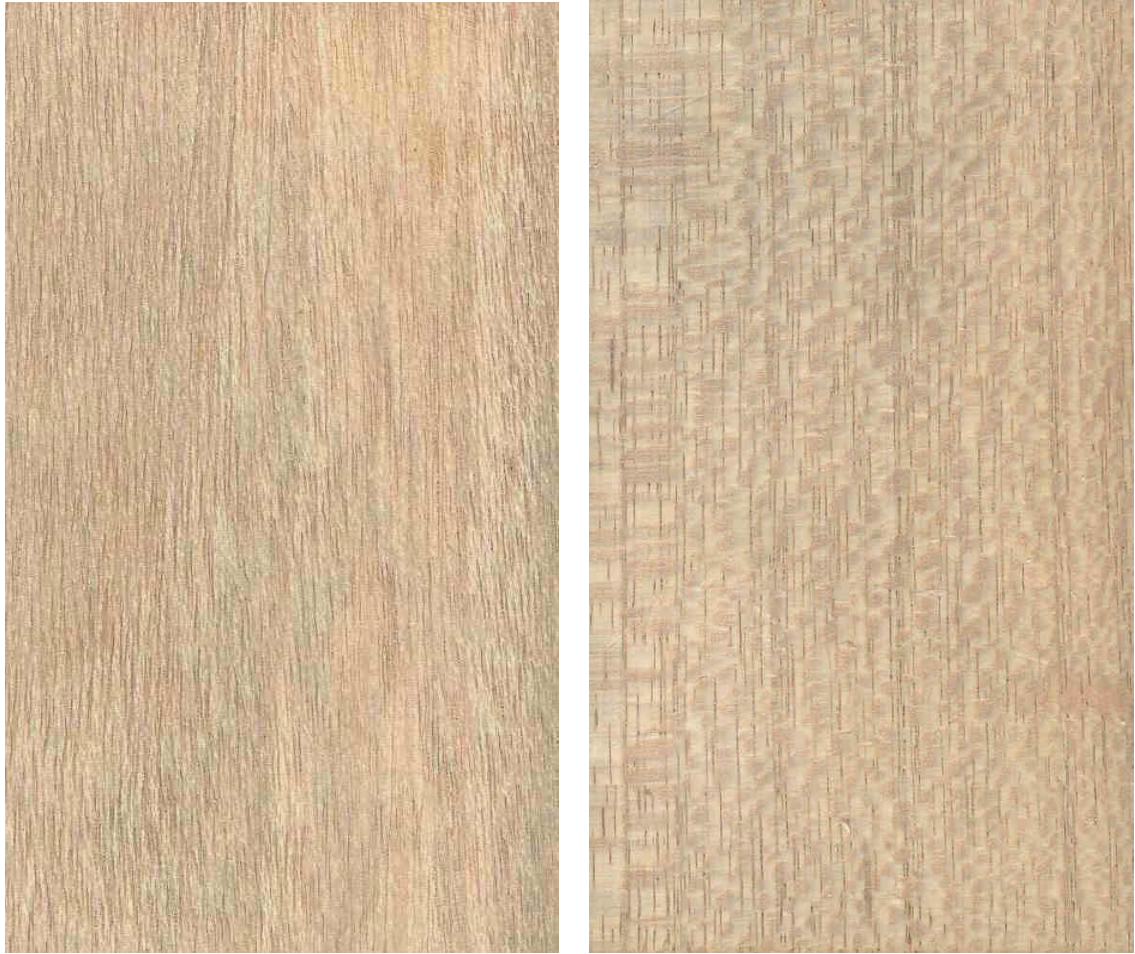
Figura 32 Madera en corte tangencial y radial de Sterculia frondosa .
