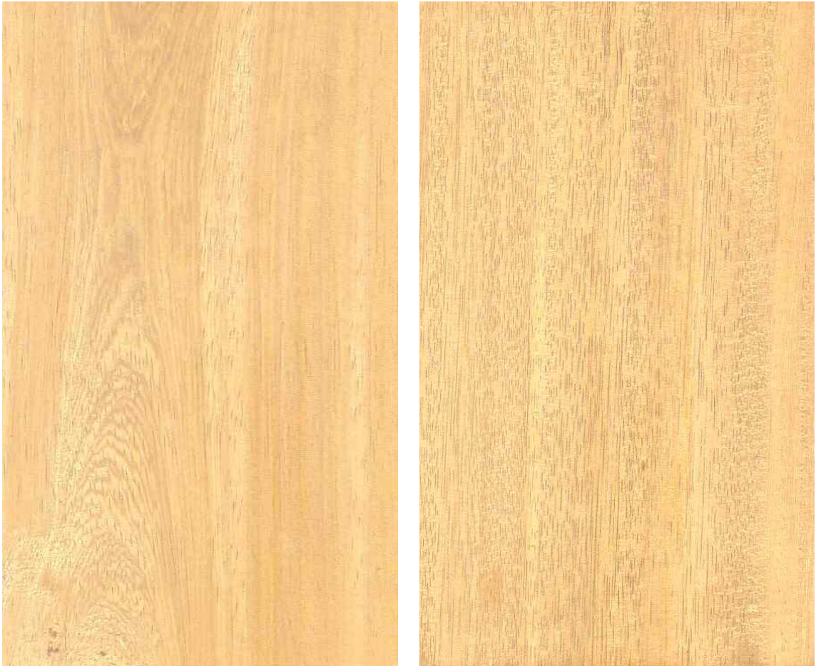
Figura 37 Madera en corte tangencial y radial de Swartzia polyphylla .
