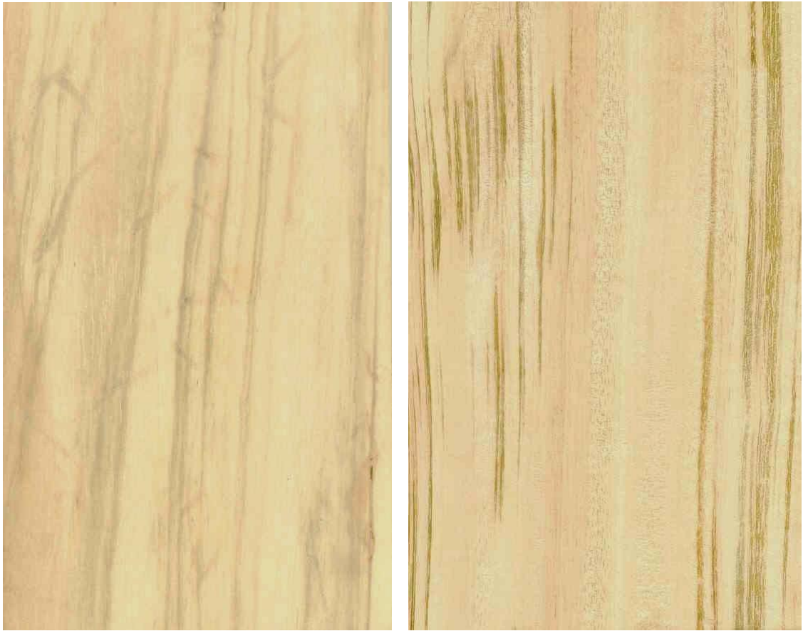
Figura 22 Madera en corte tangencial y radial de Lecythis pisonis .
